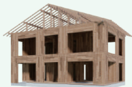
CLT パネル工法
