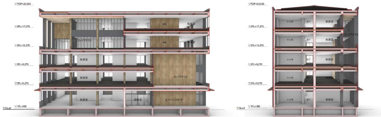
図 2.3-5 普及モデルの断面構成
