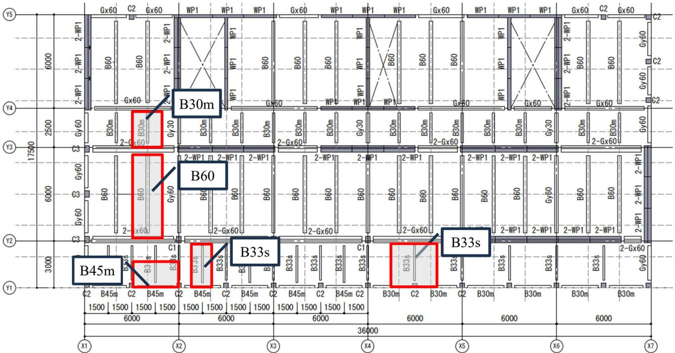
図 3.10.2-1 小梁断面算定位置
