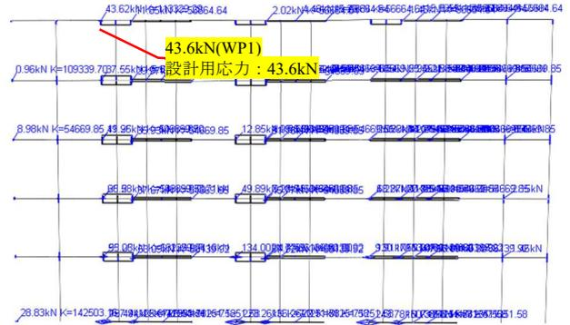
⑥壁—壁引張力最大箇所 (Y5/X2~)
