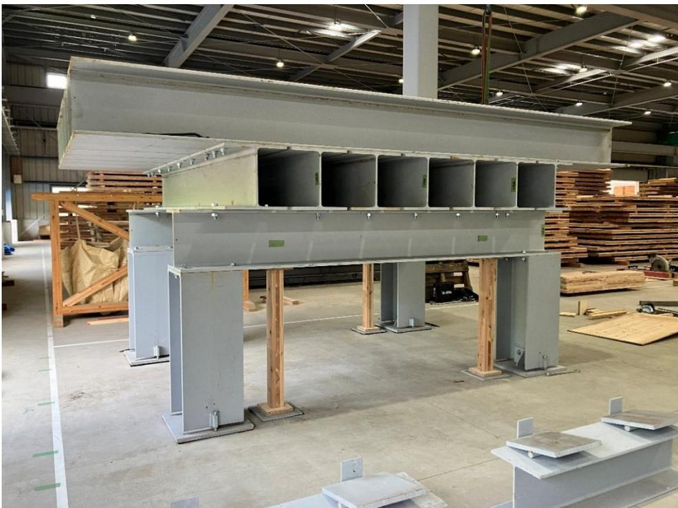
[図 2.2) - (1) -1 縦圧縮載荷試験の状況]
