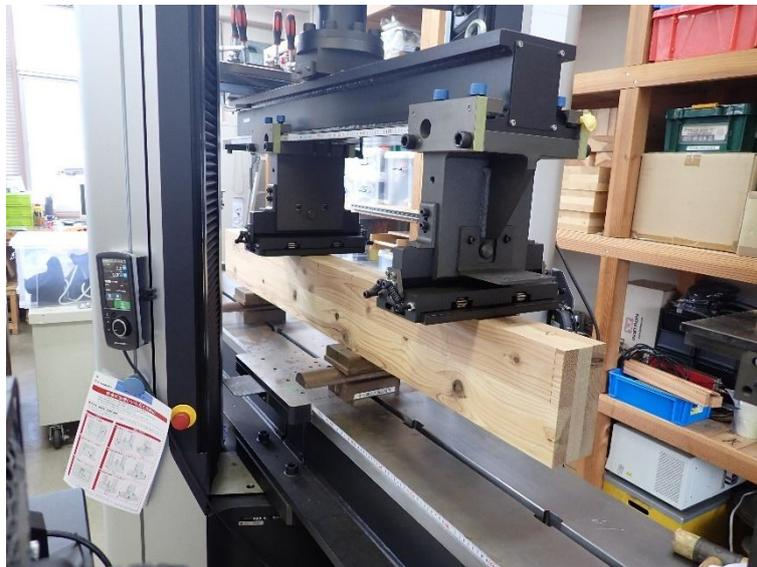
[図3.)-3)-(2)-(A)-1 面内せん断試験の様子]
