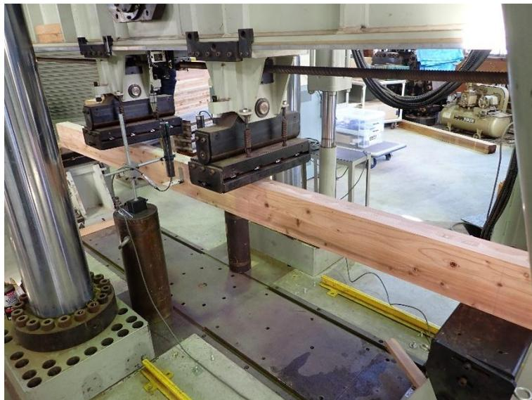
[図 3.) -2) - (2) - (A) -1 面内曲げ試験の様子]
