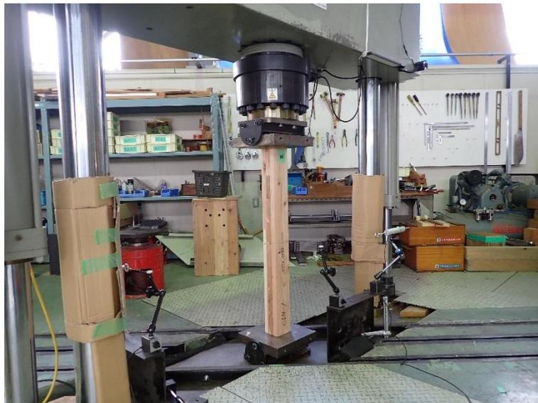
[図3.)-4)-(2)-(A)-1 縦圧縮試験の様子]
