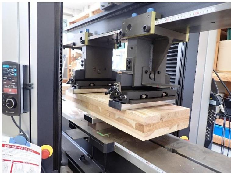
[図3.)-3)-(1)-(A)-1 面外せん断試験の様子]
