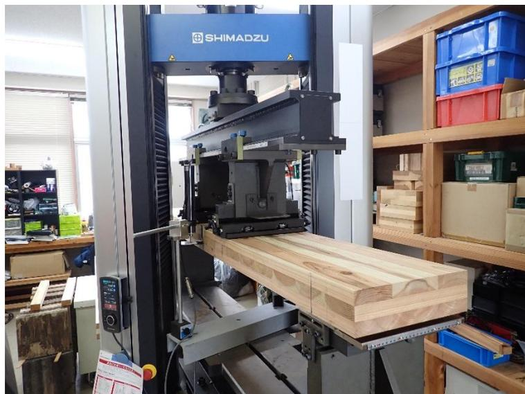
[図3.)-2) - (1) - (A) -1 面外曲げ試験の様子]
