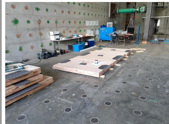
第一期 CLT パネル 挿入プレート確認
