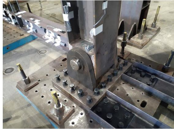
試験体固定 M24 ボルト穴位置確認 (左：加力側 右：非加力側)
