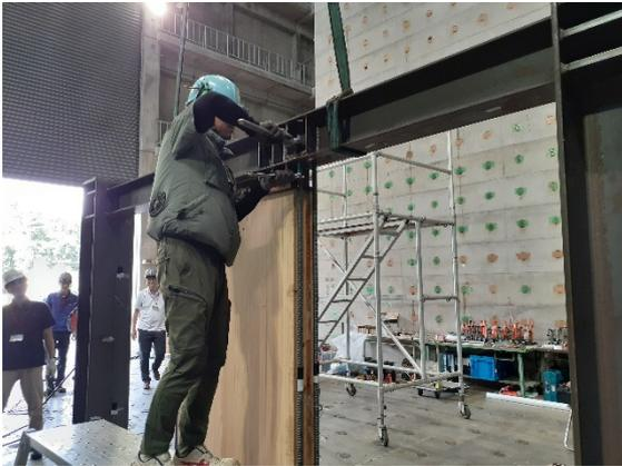
ネジ鉄筋締め（グラウト注入口の向き確認）
