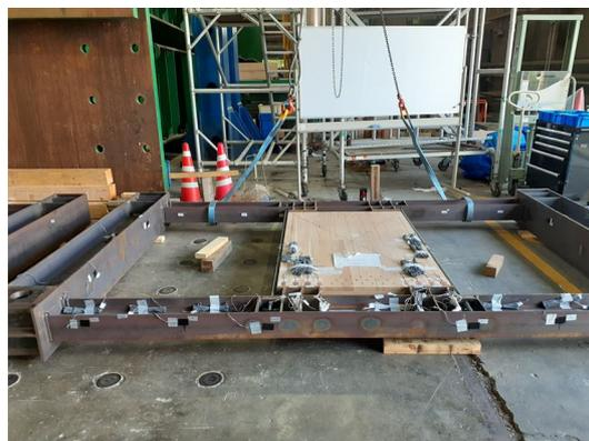
試験体 1s ひずみゲージ貼り付け作業
