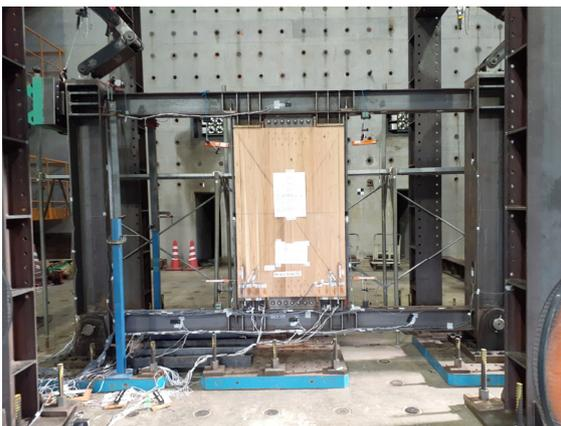
ひずみゲージ スイッチボックスへ接続 一部変位計取り付け
