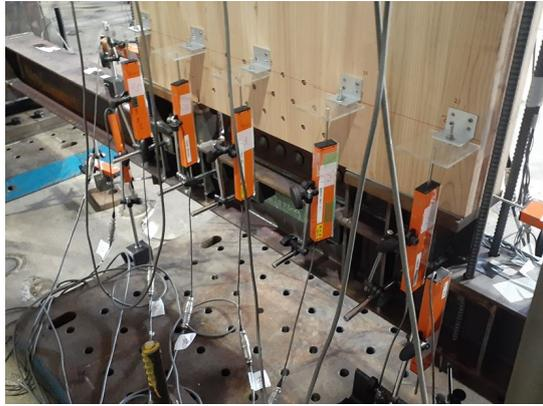
CLT 脚部 CLT と鉄骨相対変位
