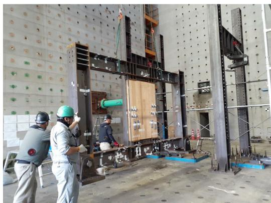
試験装置に試験体挿入
