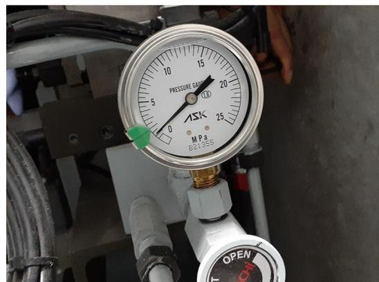
引張試験機 つかみ部圧力調整後
