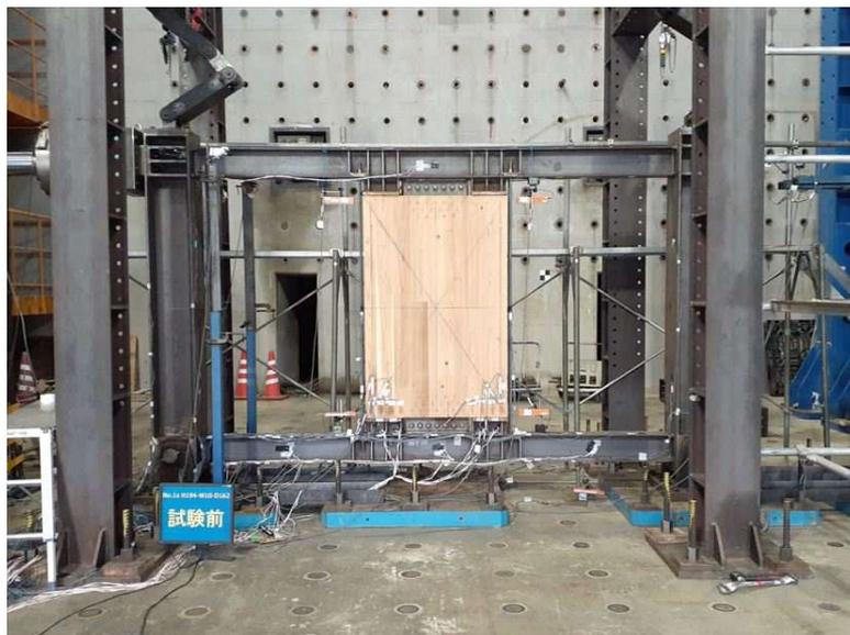
**写真 3.1 試験装置図 (1s 試験体設置時)**
