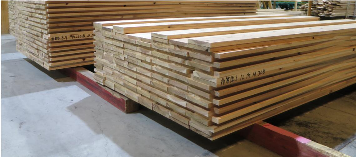
写真 2. 2. 1-1 非等厚構成 CLT の製造に用いた乾燥後ラミナ（スギ）
