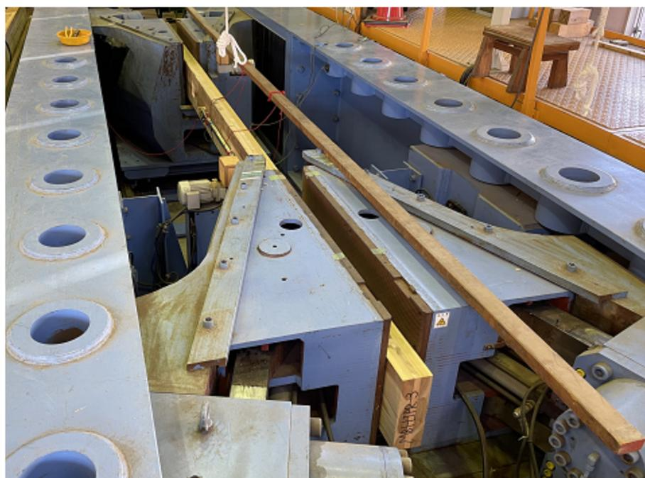
写真 2.4.2-1 非等厚構成 CLT の引張り試験の実施状況（スギ3層3プライ、40-20-40mm 構成）
