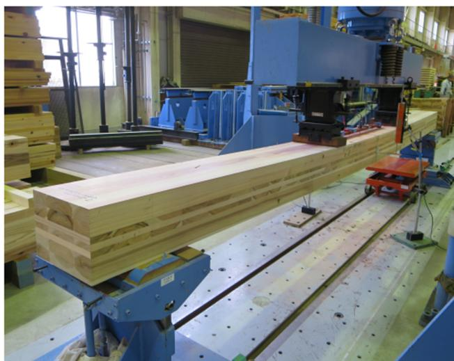
写真 2.4.4-1 非等厚構成 CLT の曲げ試験の実施状況
