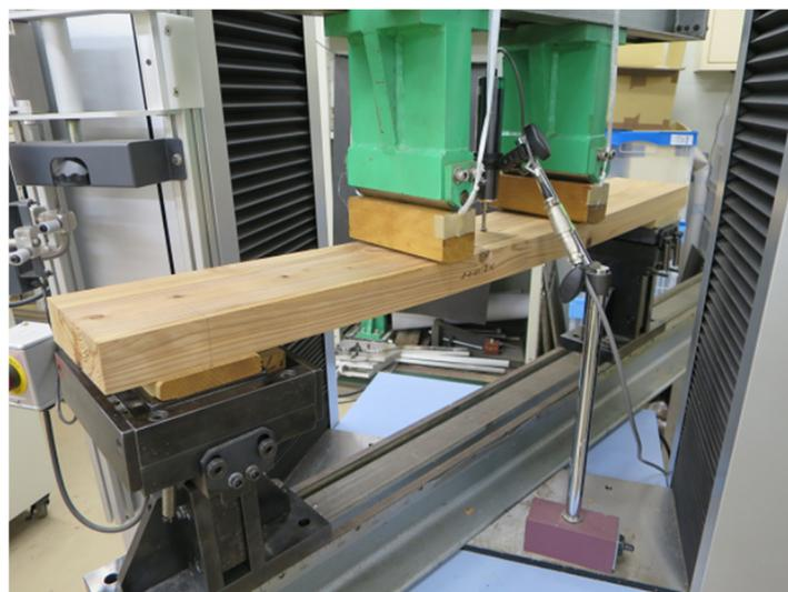
写真 2.3.4-1 FJ ラミナの曲げ試験の実施状況（スギ、ラミナ厚さ 40mm）
