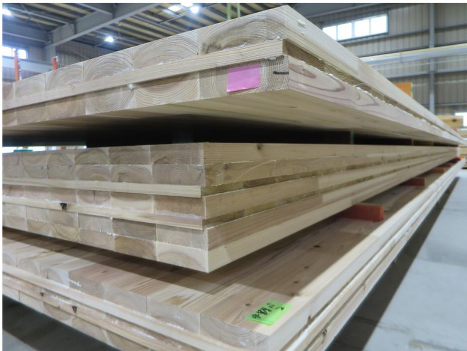
写真 2.2.2-1 製造した非等厚構成 CLT（スギ）の大版パネル
