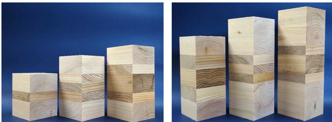
写真 2.5.3-1 スギ非等厚構成 CLT の接着試験体
