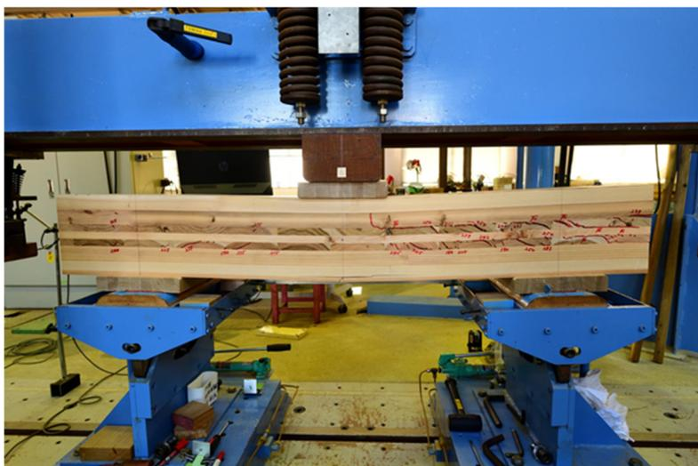
写真 2.4.5-1 非等厚構成 CLT のせん断試験の破壊状況
