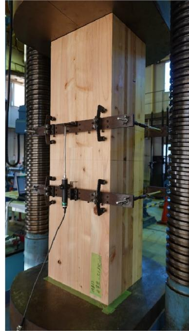
写真 2.4.3-1 非等厚構成 CLT の圧縮試験の実施状況
