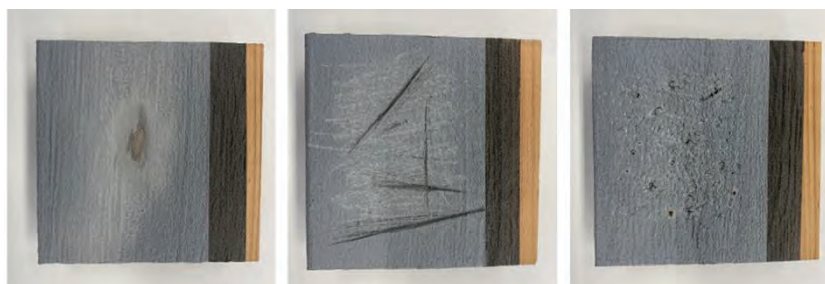
写真 1.3-2 塗装の限度見本（左：摩耗、中：切傷、右：突き傷）
