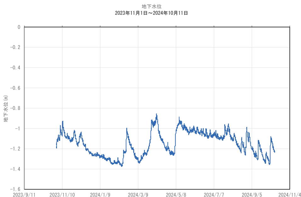
図 3.2-16 旭川市 林産試験場 地下水位
