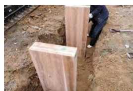
写真 3.1-2 ボード型 供試体 500 mm × 1500 mm × 150 mm
