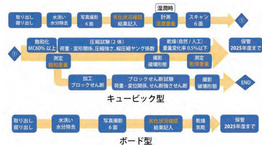
図 1.1-1 各供試体の検証フロー
