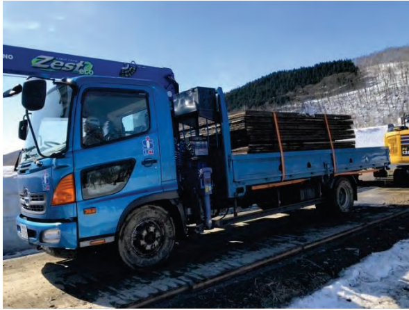
写真 5.1-6 小型クレーン車による運搬
