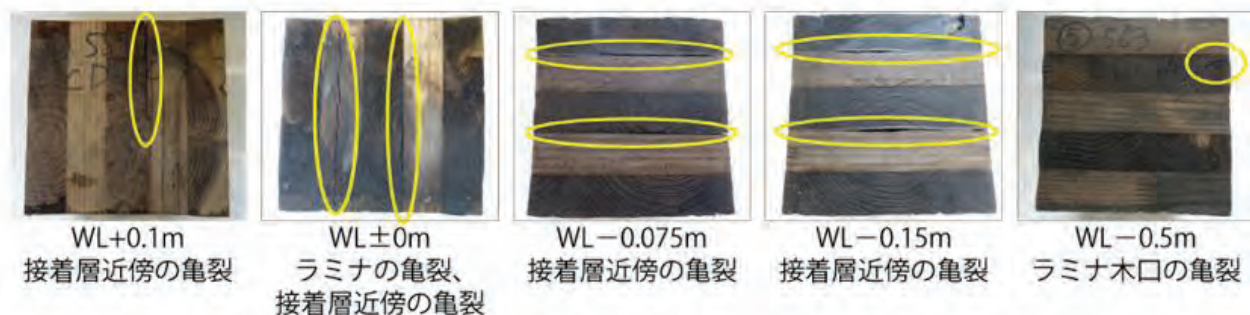
写真 1.1-6 淡水環境(野田) キュービック供試体の劣化状況
