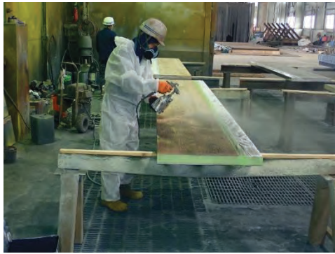
写真 5.3-11 CLTマットへの塗布と塗布後の様子
