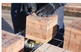
写真 3.1-1 キュービック型 供試体 150 mm × 150 mm × 150 mm
