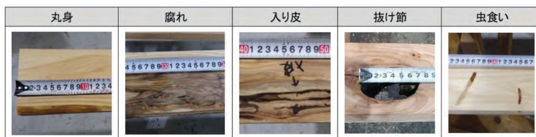
図 1.2-1 JAS におけるラミナ品質基準に適合しないラミナの例
