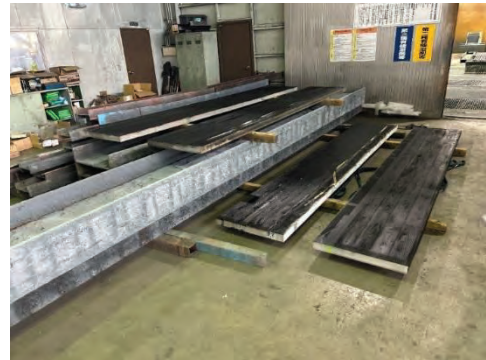
写真 5.3-11 CLTマットへの塗布と塗布後の様子
