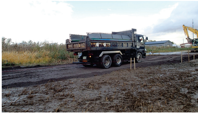
写真-12 10tトラックの走行状況
