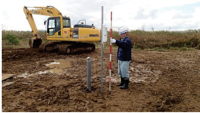
写真-9 百葉箱（温湿度計測）と地下水位観測の様子
