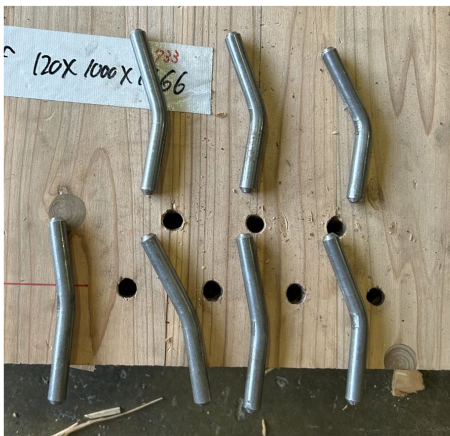
写真 3. 3-8 試験後のドリフトピン (No. 1f)
