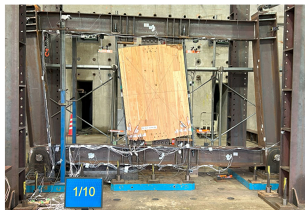
図 3.3-3 荷重 (Q) - 層間変形 ( \delta ) 関係と最終破壊状況 (No. 1f)
