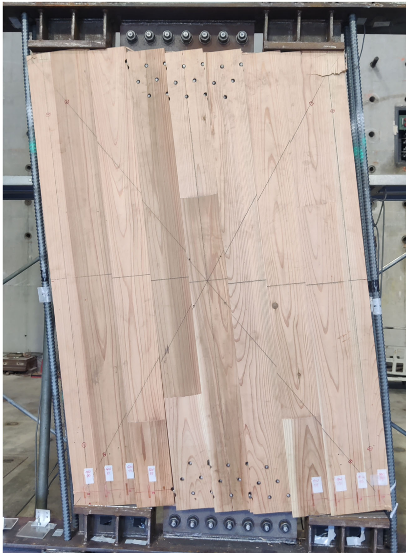
写真 3. 3-3 セン断破壊の状況 (No. 1b)
