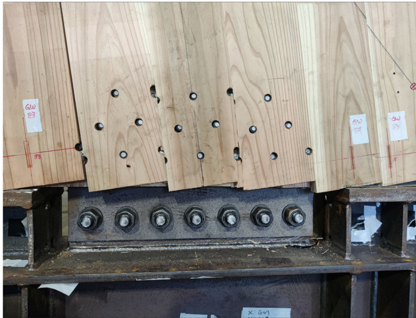
写真 3. 3-4 セン断破壊のラミナのずれ (No. 1b)
