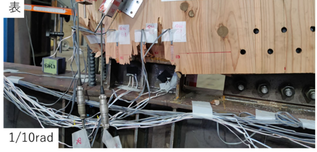
写真 3. 3-1 支圧部の破壊状況 (No. 1f)
