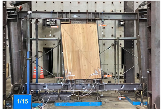
図 3.3-4 荷重 (Q) - 層間変形 ( \delta ) 関係と最終破壊状況 (No. 1s)
