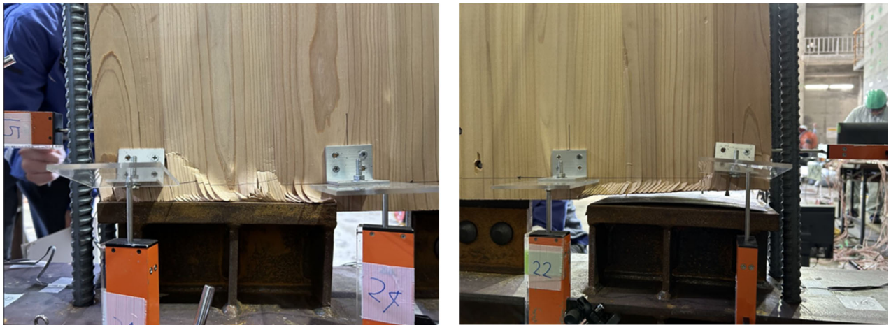
写真図 3.3-9 正加力時の CLT と上下の相対鉛直変位分布
