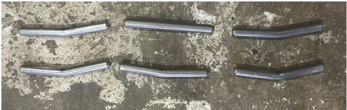
写真 3.3-7 試験後のドリフトピン (No. 1s)
