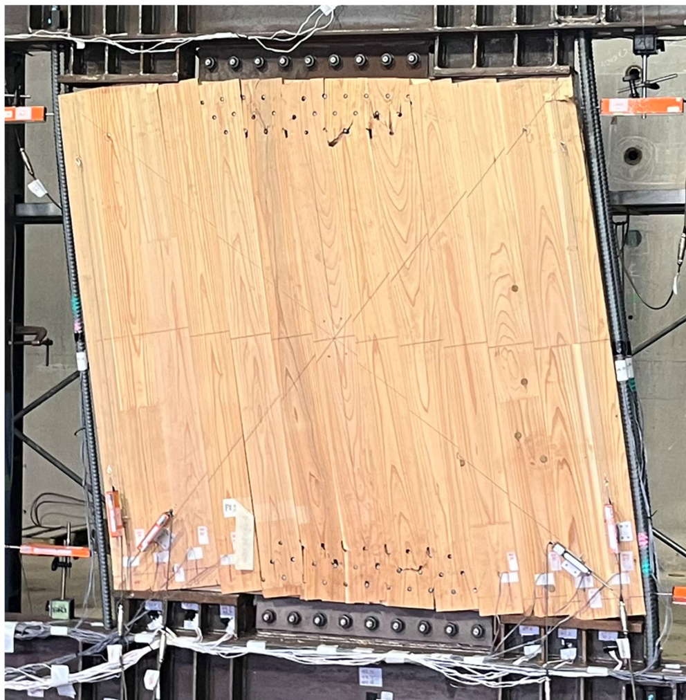
写真 3. 3-5 セン断破壊の状況 (No. 2b)
