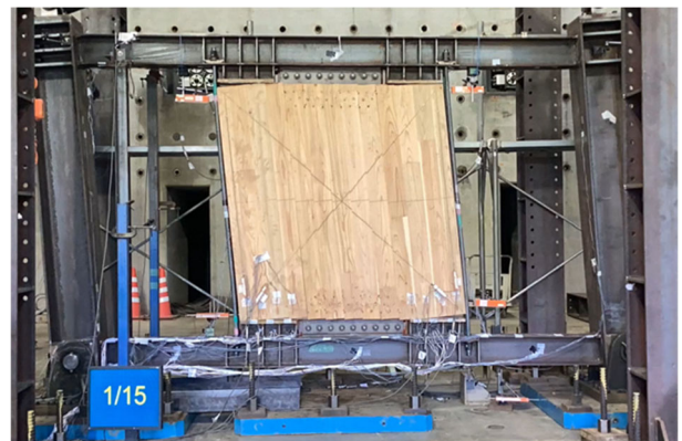
図 3.3-5 荷重 (Q) - 層間変形 ( \delta ) 関係と最終破壊状況 (No. 2a)
