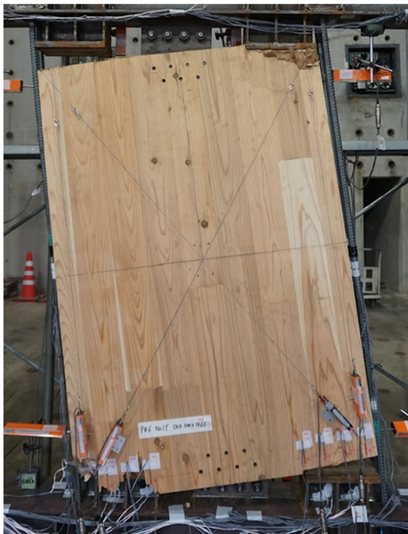
写真 3. 3-2 支圧破壊の状況 (No. 1f)
