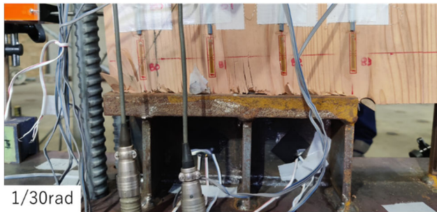
写真 3. 3-1 支圧部の破壊状況 (No. 1f)
