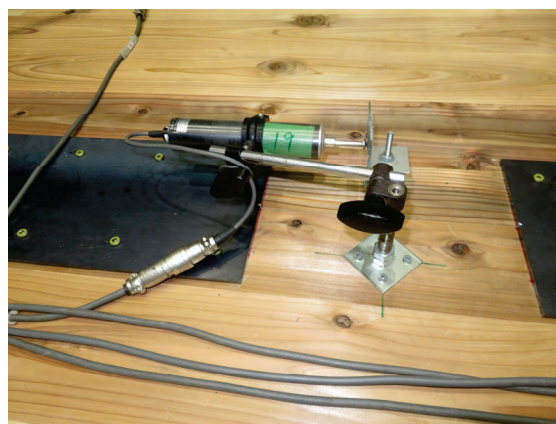
(f) 変位計設置状況 [ DT19]
