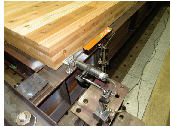
(f) 変位計設置状況 [DT1, DT5]
