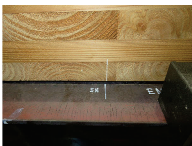
(e) 非加力側小梁-北側CLTパネルのずれ
