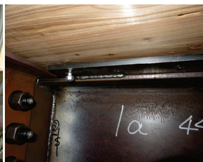
(d) 接合ビスの抜け、破断
