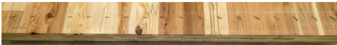
(b)ビス孔の状況 [加力側小梁－北側CLTパネル]
