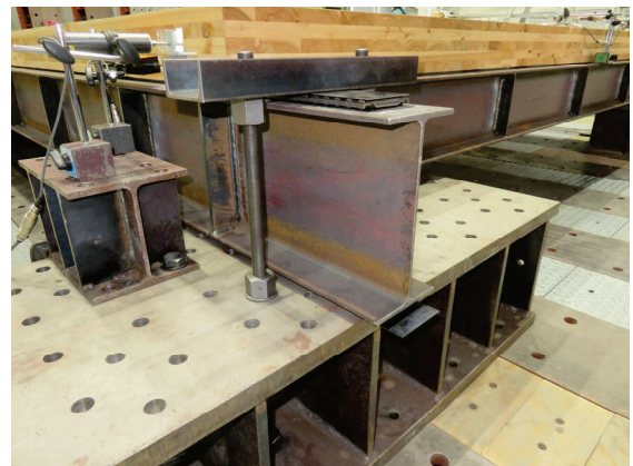
(d) 振れ止めの状況 [非加力側]
