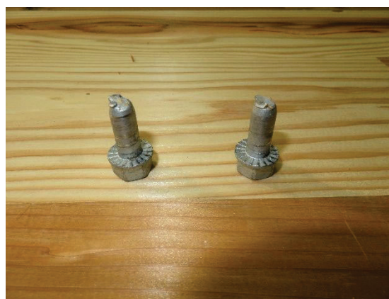
(f) 破断したビスの状況
