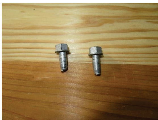
(e) 破断したビスの状況
