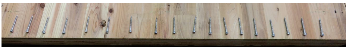
(f) ビスの状況 [加力側小梁－北側CLTパネル]
