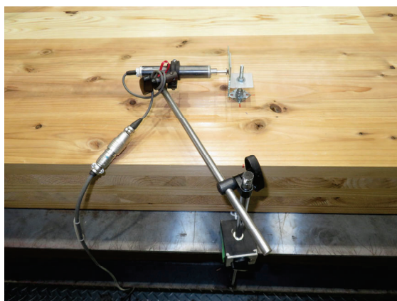
(g) 変位計設置状況 [ DT20]
