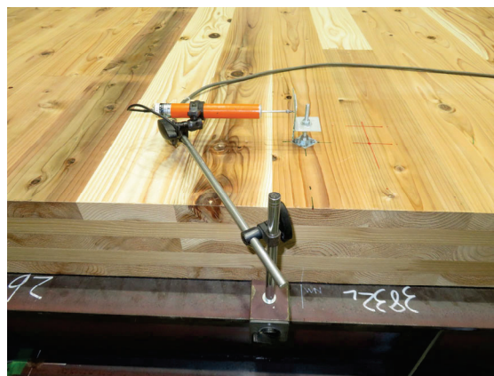
(d) 変位計設置状況 [ DT17]
