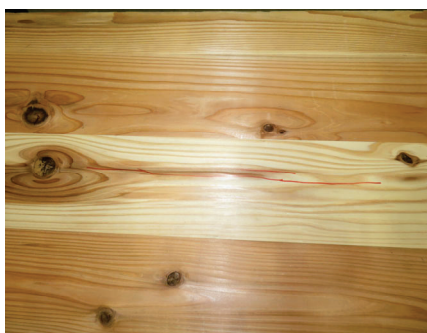
(b) CLTパネルの割り裂き
