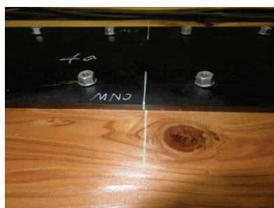
(j) スプライン接合部のずれ [北西側]
