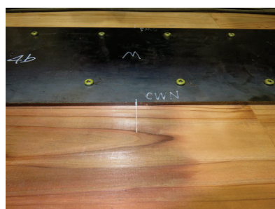
(j) スプライン接合部のずれ [北西側]
