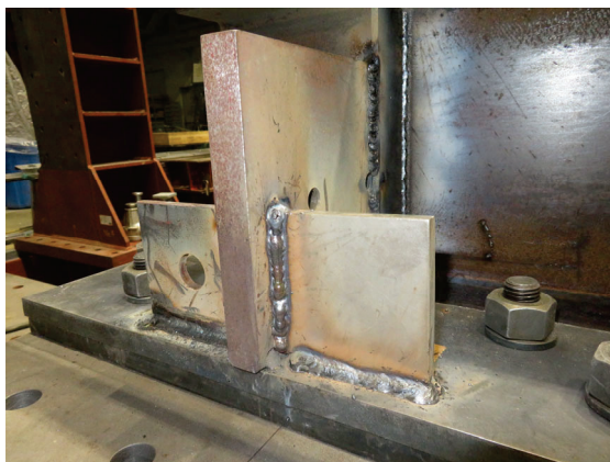
(d) 固定部追加補強の状況
