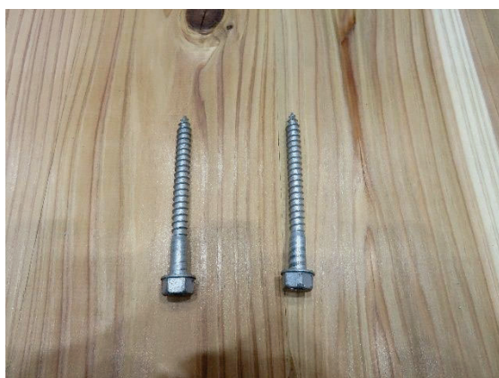
(g) 曲げ変形したビスの状況
