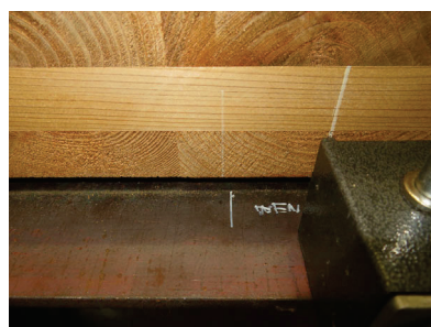
(e) 非加力側小梁-北側CLTパネルのずれ
