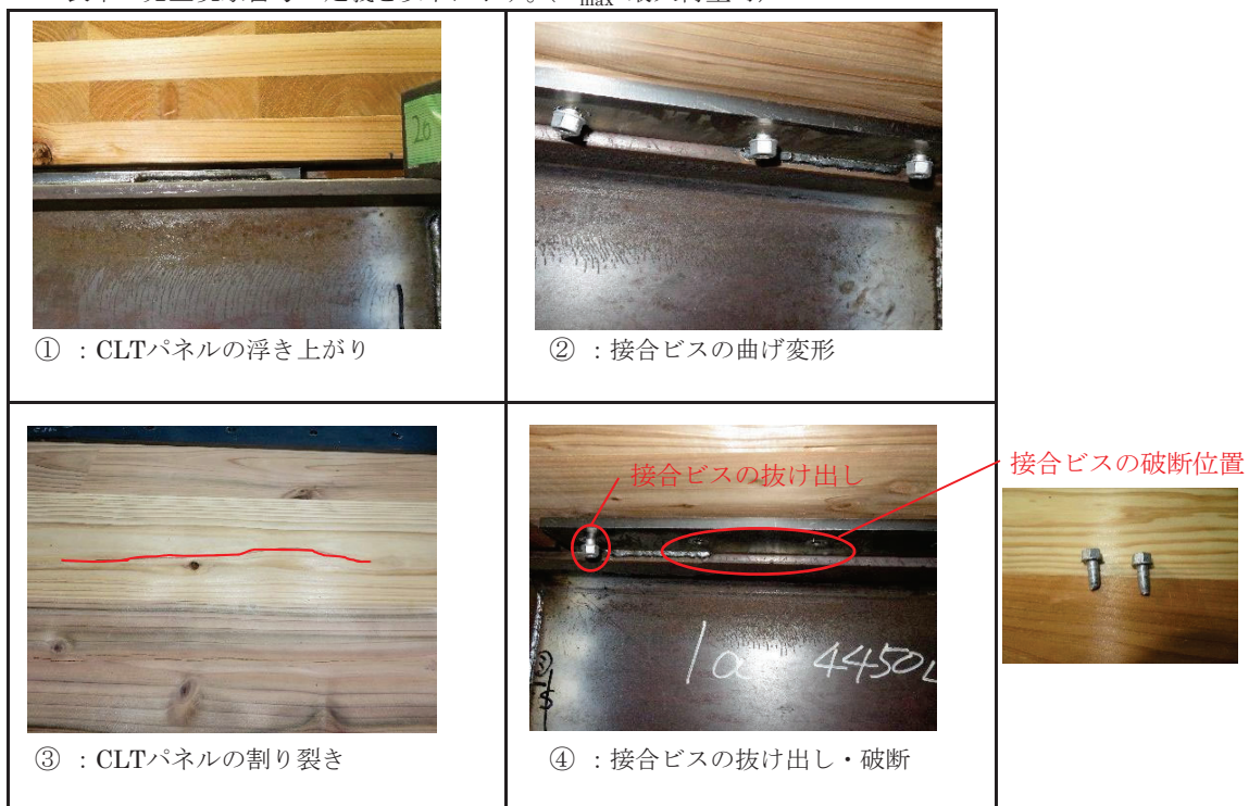
図4.1.1 Q-R関係（主な発生現象，試験体No.1）
