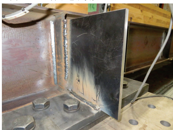
(d) 固定部追加補強の状況
