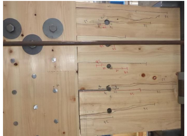
写真 5 試験終了後の状況 番号:1 ・垂れ壁パネルの割れ ・ドリフトピンの変形
