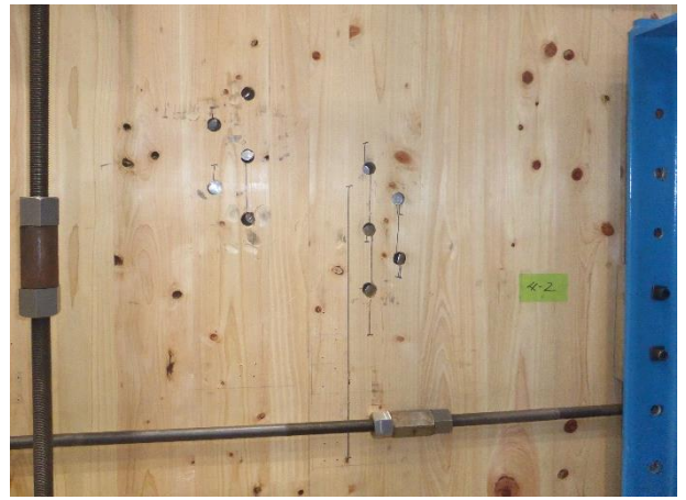
写真 3 試験終了後の状況 番号:0 ・壁パネルの割れ ・ドリフトピンの変形
