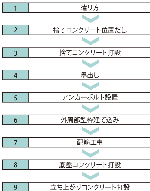
図 2-1-1 基礎工事 標準作業フロー
