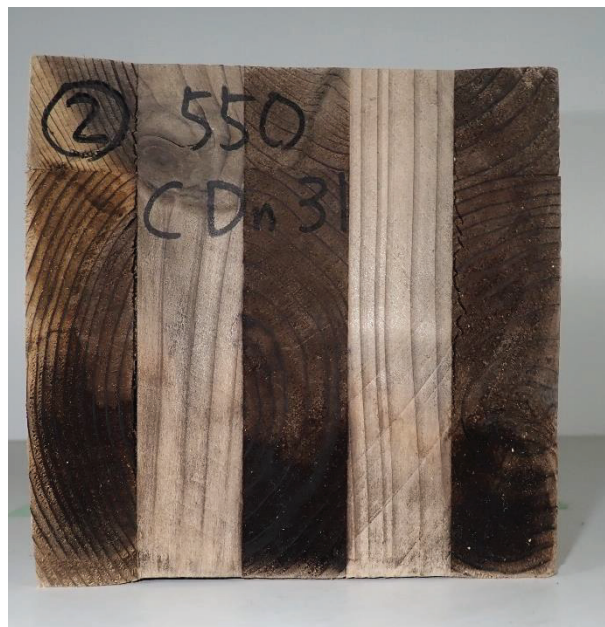
写真 5.1.2-2 接着剥離、ラミナ亀裂
