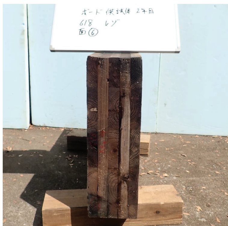
写真 5.2-8 ラミナ亀裂、接着剥離
