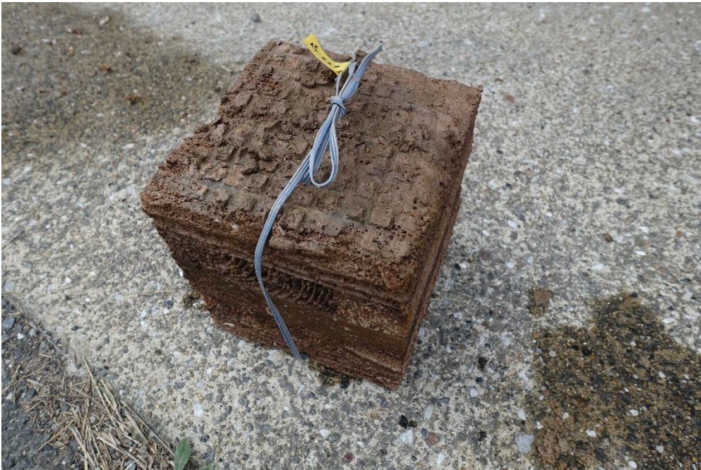
写真 4.1.3-3 上面ラミナの表面にキクイムシ(甲殻類)の糞と思われるものが、メッシュコンテナの網目状に堆積
