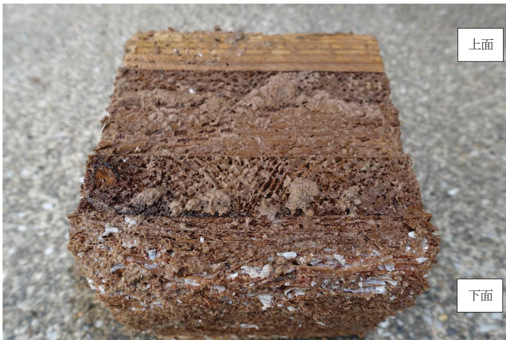
写真 4.1.3-2 キクイムシ(甲殻類)の食害 下面に特にフナクイムシの食害が多い
