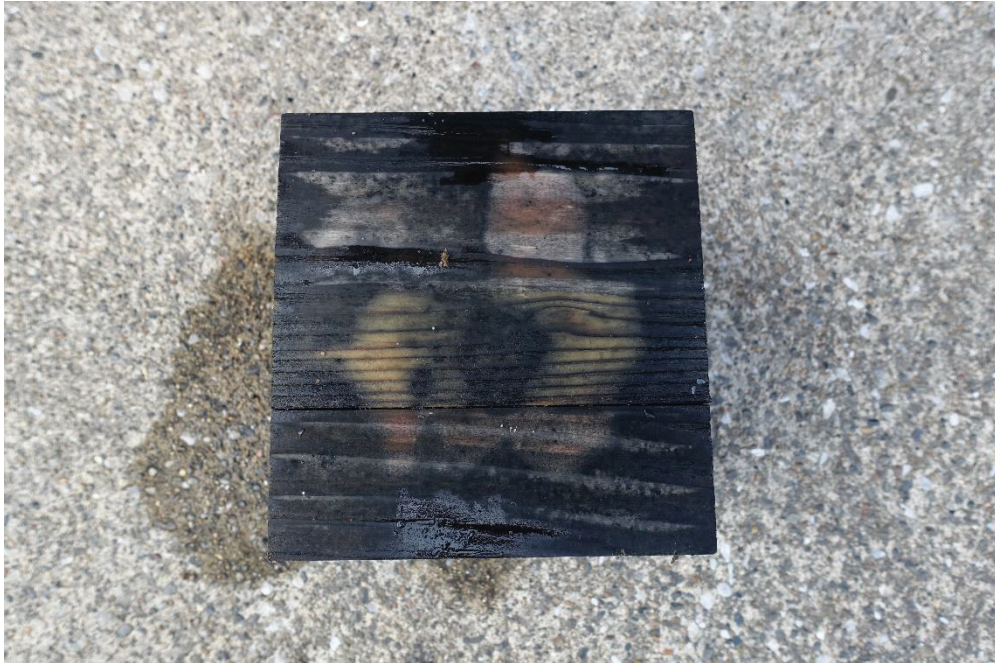
写真 4.1.7-1 幅はぎ部分に隙間
