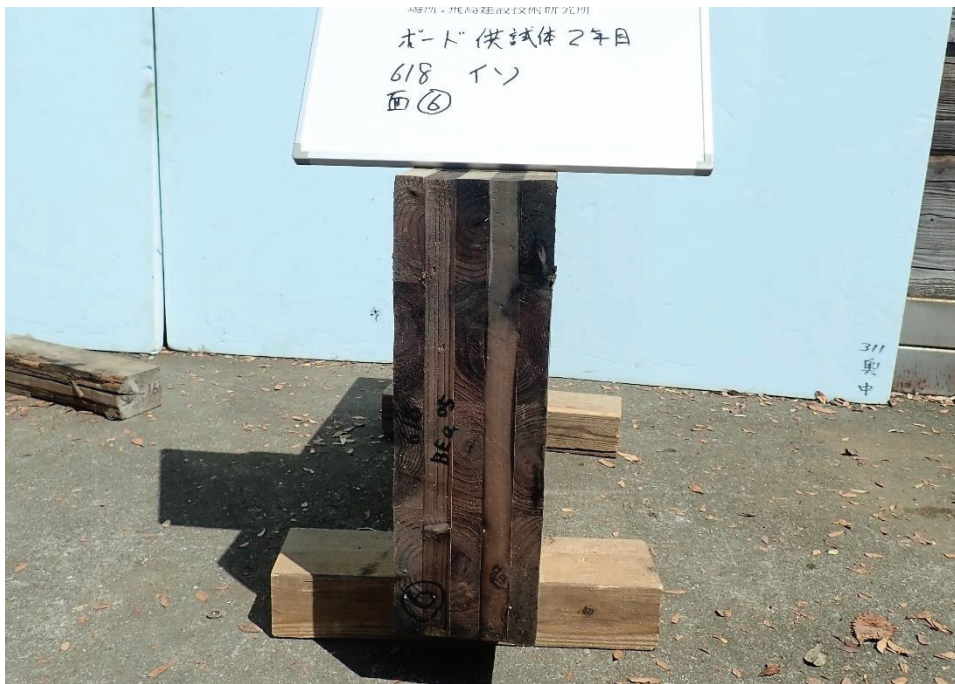
写真 5.2-4 僅かにラミナ亀裂
