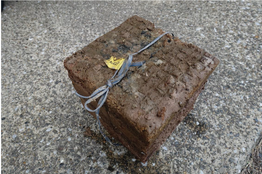
写真 4.1.3-1 上面ラミナの表面にキクイムシ(甲殻類)の糞と思われるものが、メッシュコンテナの網目状に堆積
