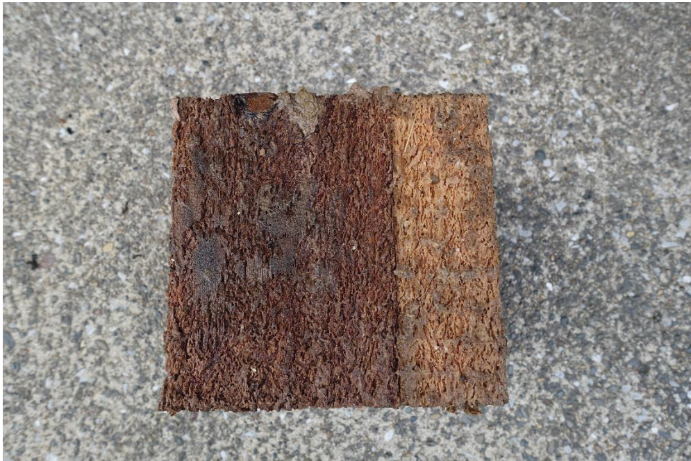
写真 4.1.2-2 下面のラミナ全体にキクイムシ(甲殻類)の食害あり。表面にぬめりあり。
