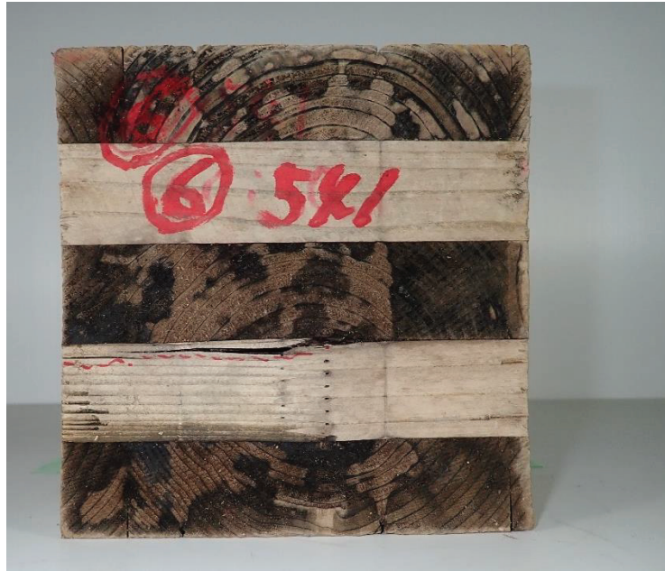
写真 5.1.3-3 ラミナの亀裂
