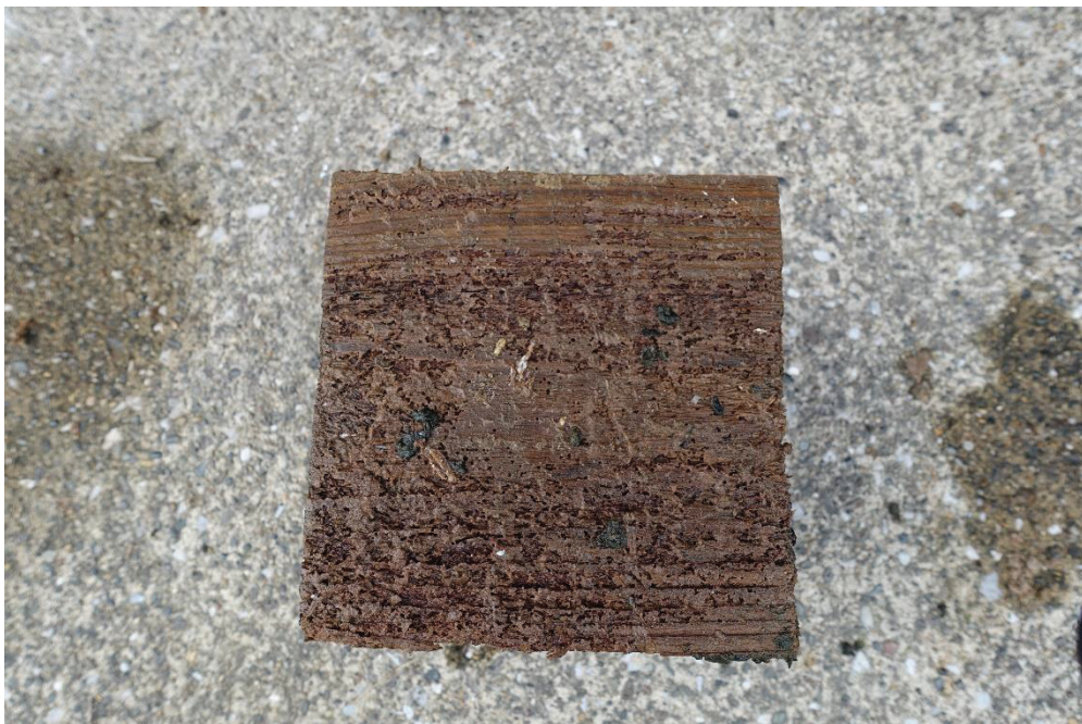
写真 4.1.2-4 下面ラミナにキクイムシ(甲殻類)の食害
