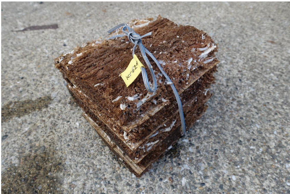
写真 4.1.1-3 フナクイムシ、キクイムシ(甲殻類)による食害
