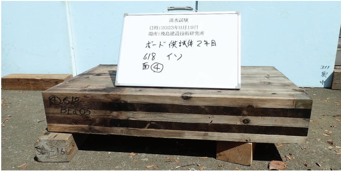
写真 5.2-3 僅かにラミナ亀裂
