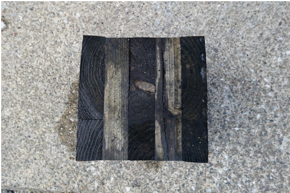
写真 4.1.7-2 ラミナ亀裂、接着剥離
