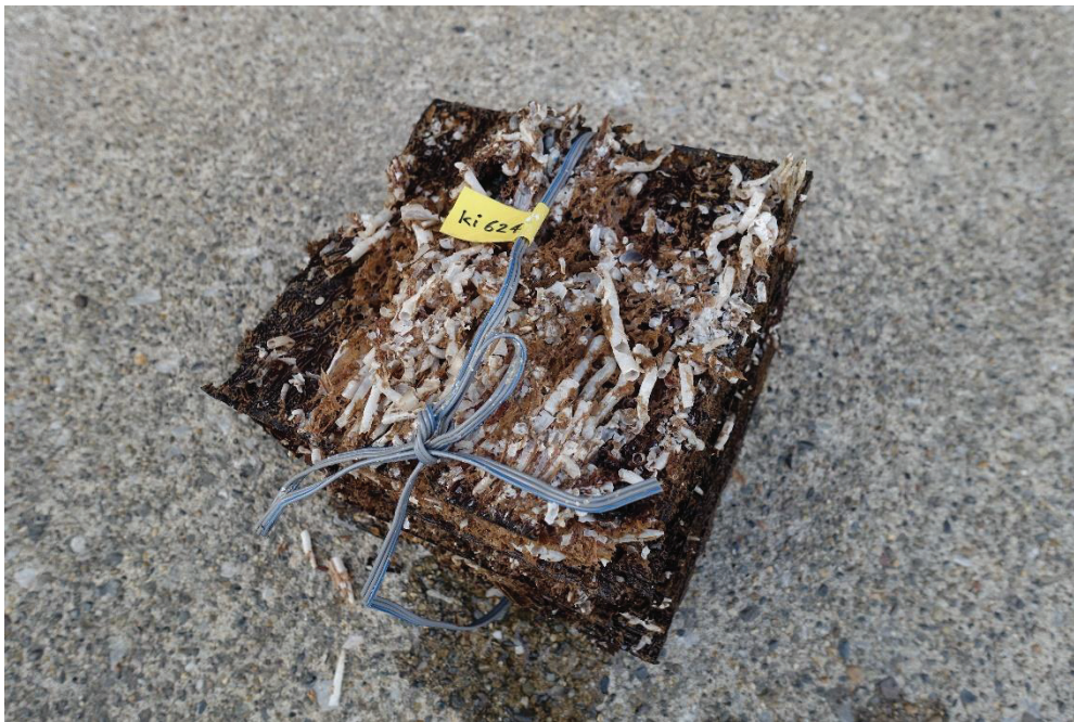
写真 4.1.1-1 フナクイムシ、キクイムシ(甲殻類)による食害
