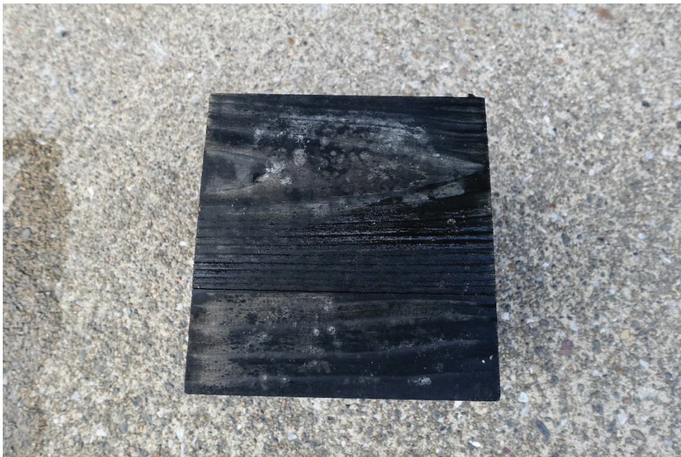
写真 4.1.5-1 幅はぎ部分に隙間、土中部分黒色に変色
