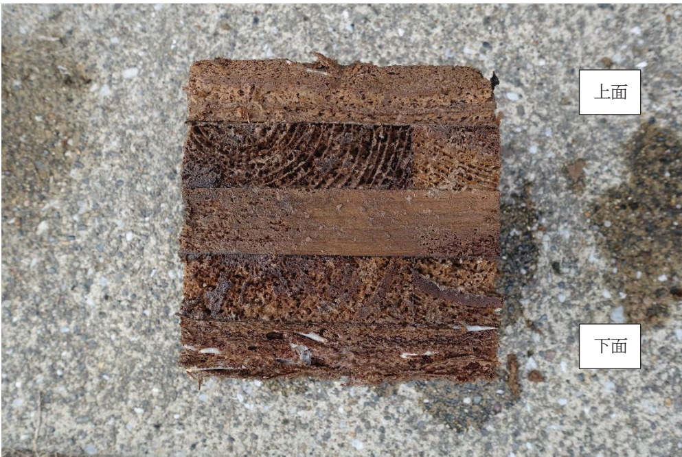
写真 4.1.3-4 キクイムシ(甲殻類)の食害、下面は特にフナクイムシの食害が多い
