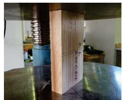
写真 2.4.2-1 FJ ラミナの縦圧縮試験の状況 (左から、スギ厚さ 20mm、30mm、40mm)
