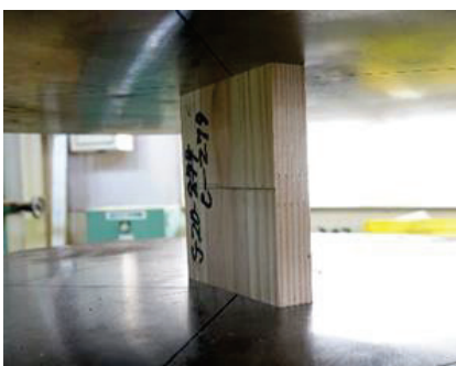
写真 2.4.2-1 FJ ラミナの縦圧縮試験の状況 (左から、スギ厚さ 20mm、30mm、40mm)
