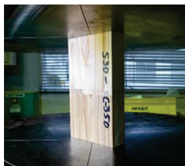
写真 2.4.2-1 FJ ラミナの縦圧縮試験の状況 (左から、スギ厚さ 20mm、30mm、40mm)
