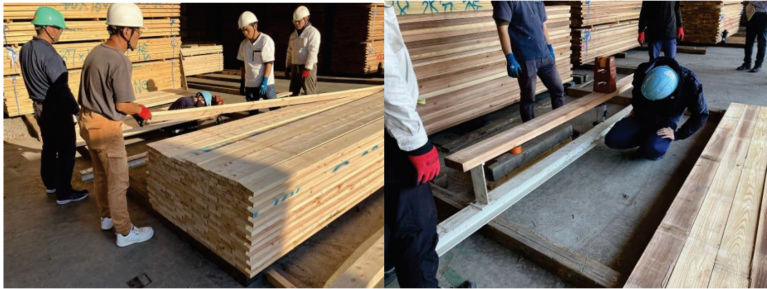
写真 2.2.3-2 ヒノキ・スギラミナ (ラフ) の曲げ B 試験の実施状況
