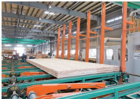
CLTパネル製造
