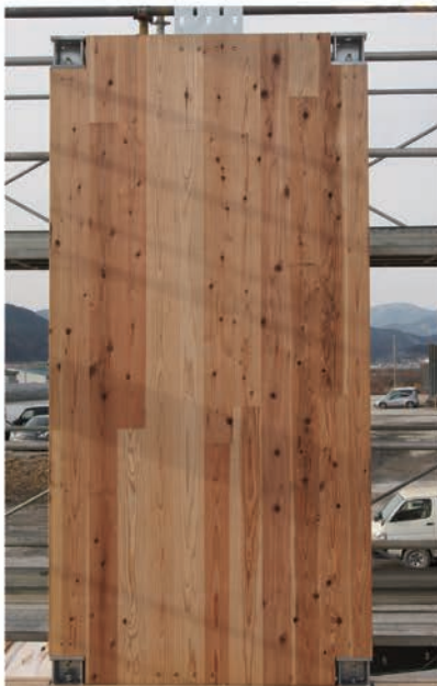
四隅に引張接合金物を設けたCLTパネル
