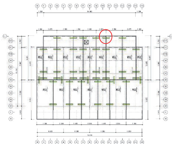
図7-4-10 引張接合部検討箇所
