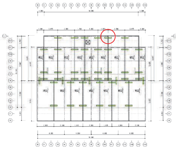
図7-4-12 引張接合部検討箇所
