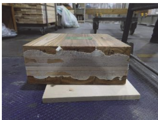
写真 3.3-1 天然乾燥材を用いた CLT(テーブルテスト試験体)
