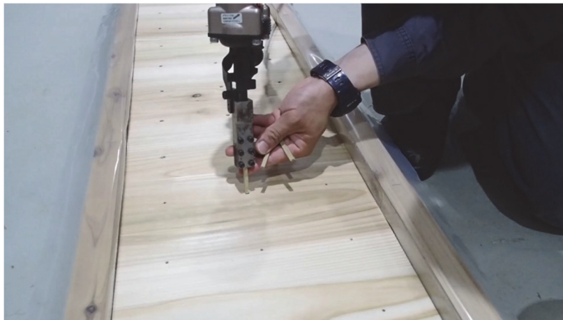
写真 3.4-2 試験風景(木釘接合)
