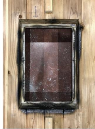
写真 1-2 仕様 1 の解体時（CLT 躯体）
