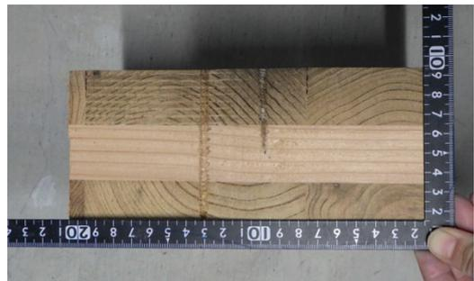
写真 1-26 仕様 3 の CLT 断面
