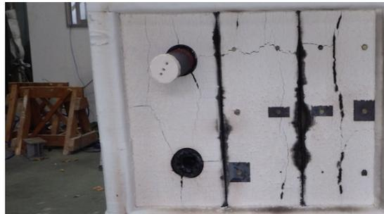
写真 3-1 実験終了時の加熱側
