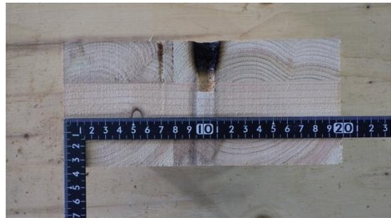
写真 2-32 仕様 14 の CLT 断面
