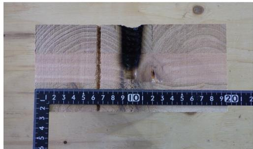
写真 2-58 仕様 27 の CLT 断面
