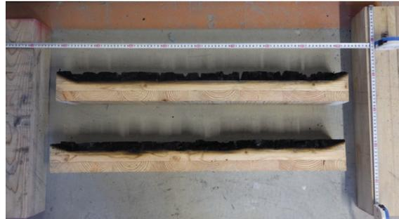
写真 30 解体時の CLT 断面
