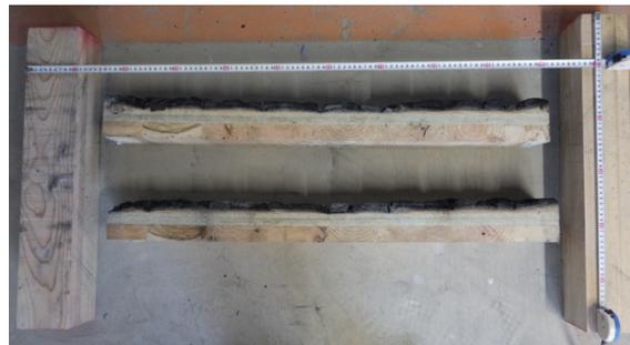
写真 32 解体時の CLT 断面
