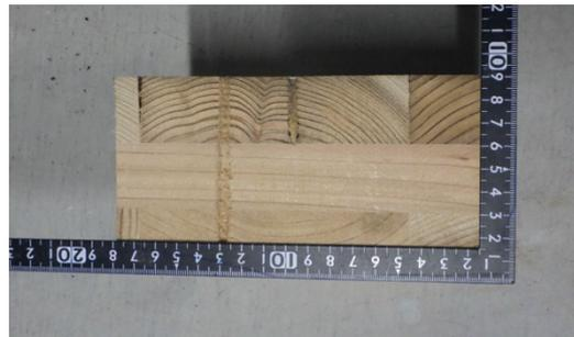
写真 1-44 仕様 11 の CLT 断面
