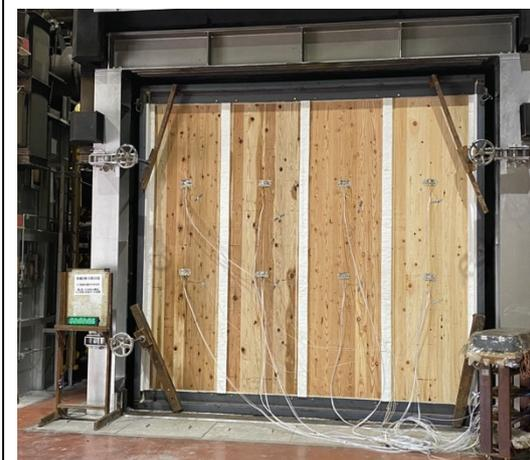
写真11 非加熱面・実験開始 120 分後
