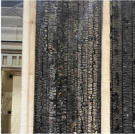
写真 21 加熱面・脱炉直後の解体時 全景
