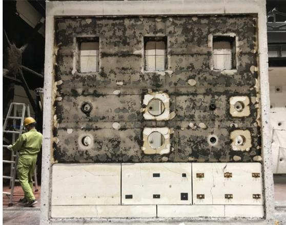
写真 1-79 加熱面・脱炉直後の解体時
