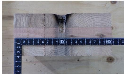
写真 2-14 仕様 5 の CLT 断面
