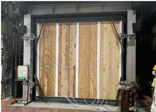
写真7 非加熱面・実験開始30分後（写真）
