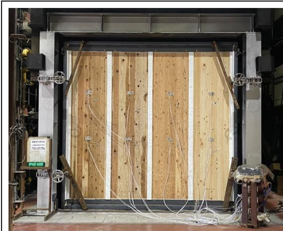
写真 15 非加熱面・実験開始 240 分後
