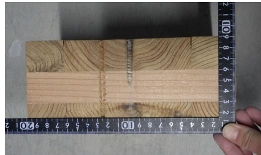
写真 1-30 仕様 5 の CLT 断面
