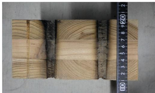
写真 1-60 仕様 19 の CLT 断面
