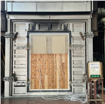
写真 2-79 非加熱面・実験開始時
