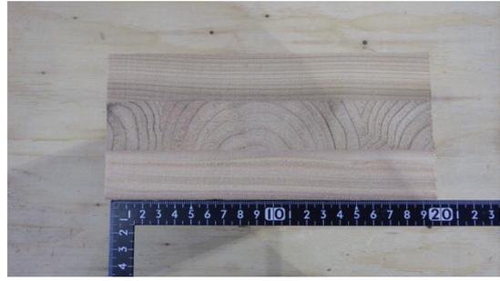
写真 3-50 仕様 22 の CLT 断面
