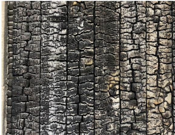
写真 22 加熱面・脱炉直後の解体時 接写
