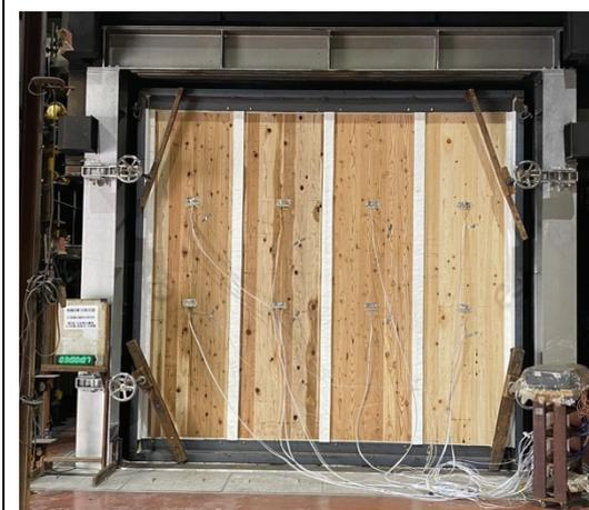
写真13 非加熱面・実験開始 180 分後
