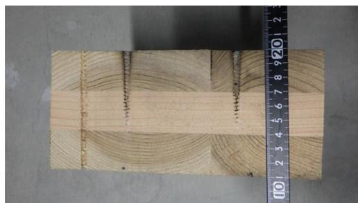
写真 1-62 仕様 20 の CLT 断面
