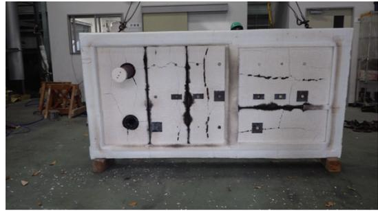
写真 3-52 加熱面・脱炉時
