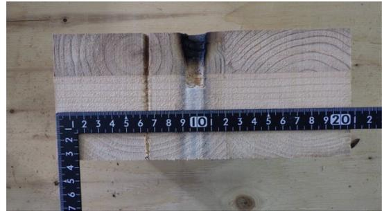
写真 2-30 仕様 13 の CLT 断面
