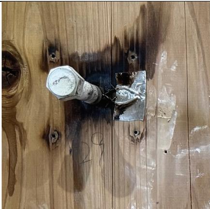
写真 2-37 仕様 17 の解体時 (CLT 表面)
