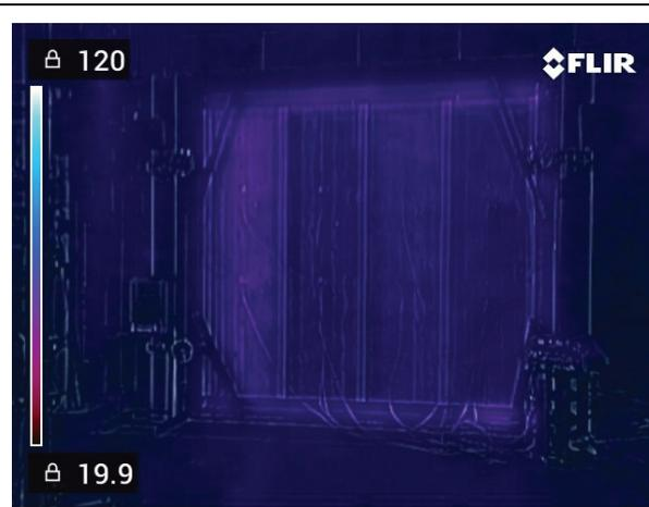
写真10 非加熱面・実験開始 60 分後
