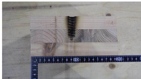
写真 3-42 仕様 18 の CLT 断面
