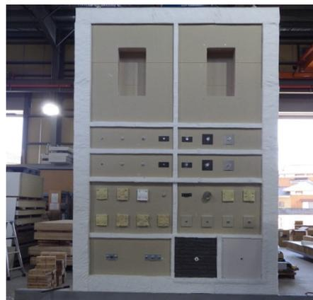
写真2 試験体2 (1時間耐火構造壁)
