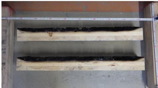
写真 29 解体時の CLT 断面
