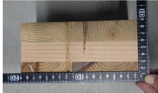
写真 1-28 仕様 4 の CLT 断面
