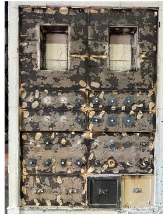
写真 2-82 加熱面・脱炉直後の解体時
