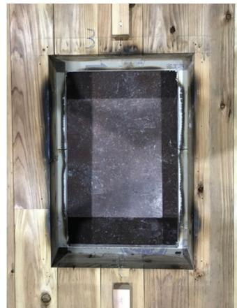
写真 1-6 仕様 3 の解体時（CLT 躯体）
