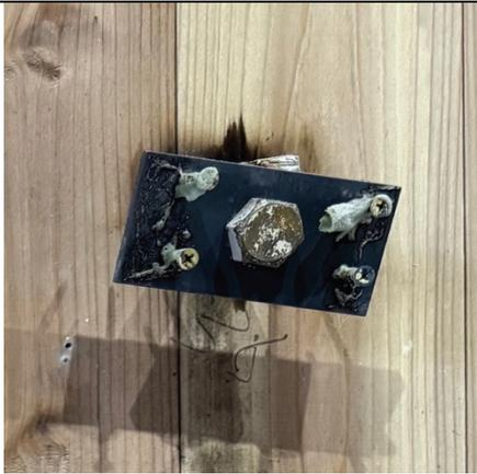
写真 2-51 仕様 24 の解体時 (CLT 表面)
