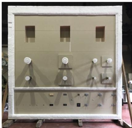
写真1 試験体1 (1時間耐火構造壁)
