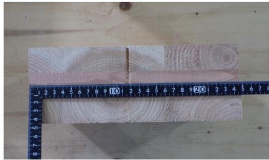
写真 2-20 仕様 8 の CLT 断面
