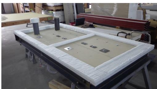
写真3 試験体3 (1時間耐火構造床)
