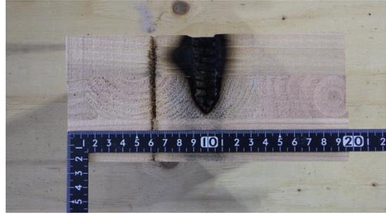
写真 3-14 仕様 4 の CLT 断面
