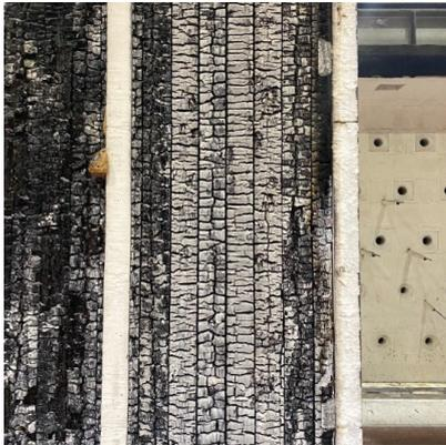
写真 27 加熱面・脱炉直後の解体時 全景
