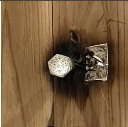
写真 2-9 仕様 3 の解体時 (CLT 表面)
