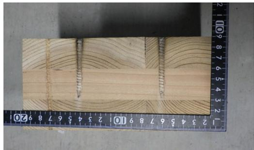
写真 1-56 仕様 17 の CLT 断面
