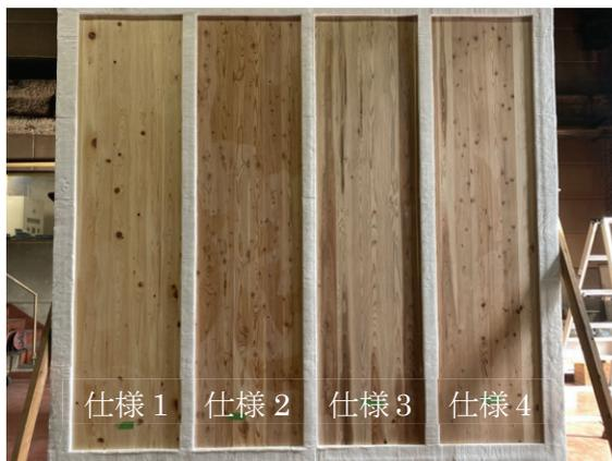
写真1 試験体（30分耐火構造外壁）
