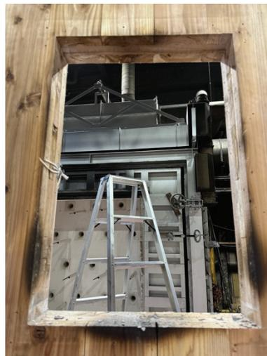
写真 2-4 仕様 2 の解体時（CLT 躯体）
