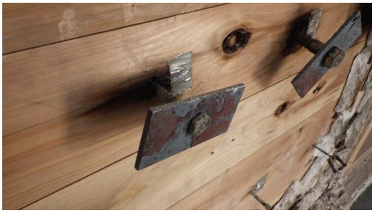
写真 3-17 仕様 6 の解体時 (CLT 表面)
