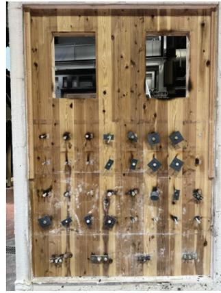
写真 2-84 加熱面・脱炉直後の解体時
