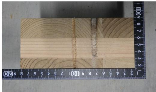
写真 1-42 仕様 26 の CLT 断面
