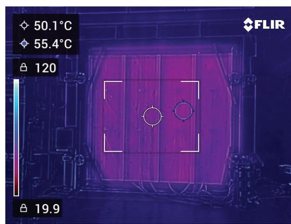
写真14 非加熱面・実験開始 180 分後
