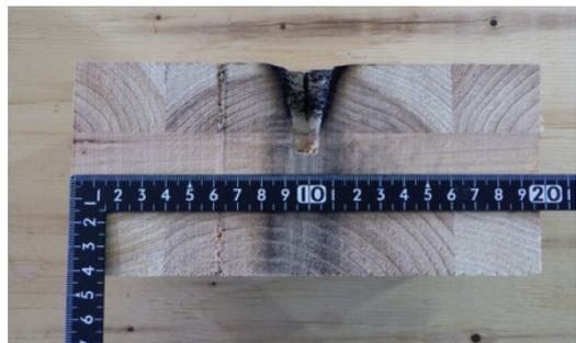
写真 2-8 仕様 2 の CLT 断面
