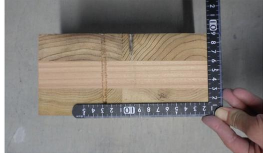
写真 1-22 仕様 1 の CLT 断面
