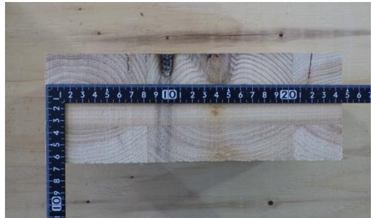
写真 2-6 仕様 1 の CLT 断面
