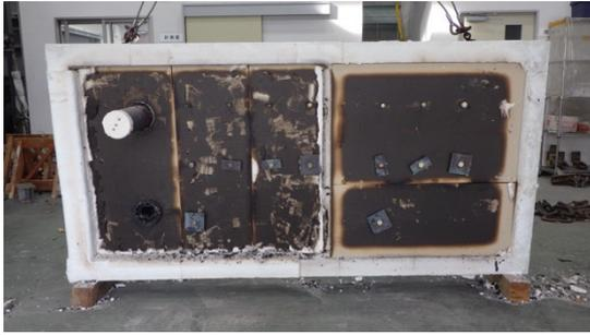
写真 3-57 加熱面・脱炉直後の解体時
