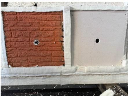
写真 2-81 加熱面・脱炉直後の解体時
