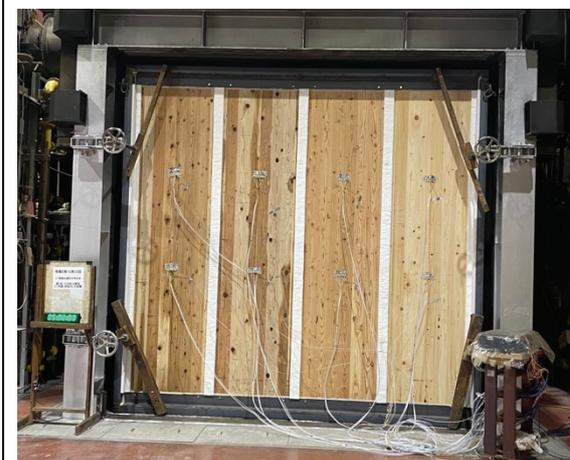
写真 17 非加熱面・実験開始 300 分後
