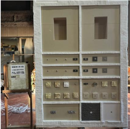
写真 2-77 加熱面・実験開始前
