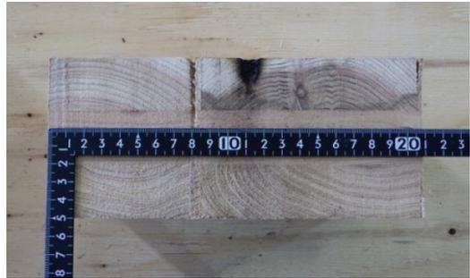
写真 2-12 仕様 4 の CLT 断面
