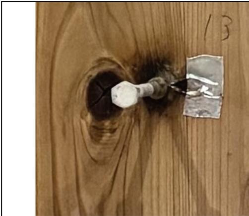
写真 2-5 仕様 1 の解体時 (CLT 表面)
