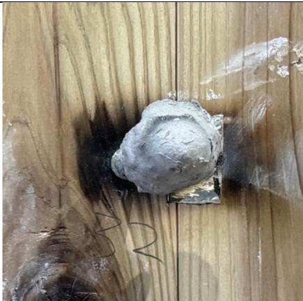
写真 2-43 仕様 20 の解体時 (CLT 表面)
