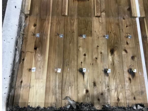
写真 1-82 加熱面・脱炉直後の解体時
