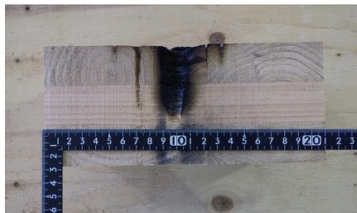
写真 2-46 仕様 21 の CLT 断面
