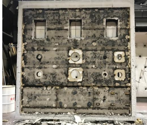
写真 1-80 加熱面・脱炉直後の解体時
