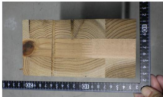
写真 1-50 仕様 14 の CLT 断面
