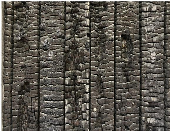
写真 24 加熱面・脱炉直後の解体時 接写
