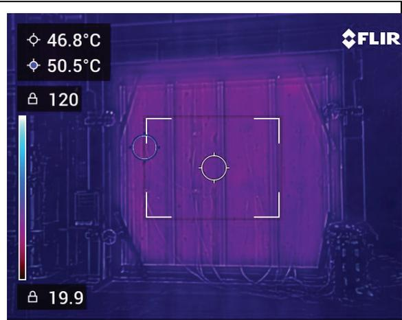
写真 16 加熱面・実験開始 240 分後
