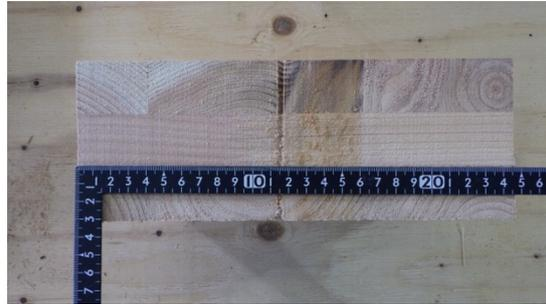
写真 2-36 仕様 16 の CLT 断面
