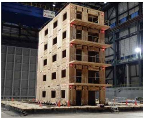
CLT パネル工法 5 階建ての実大振動台実験
