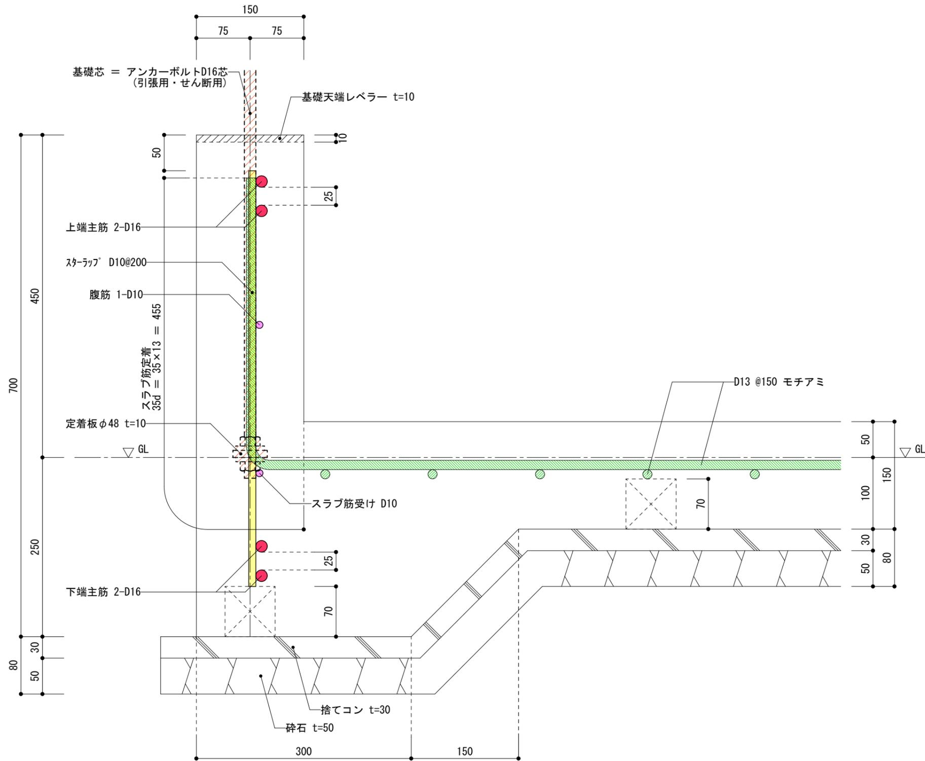
※ 立上り部の配筋は、ユニット鉄筋（BCJ評定取得）とする
