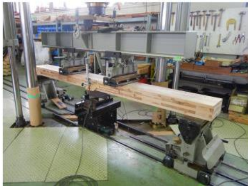
写真 面外曲げ試験
