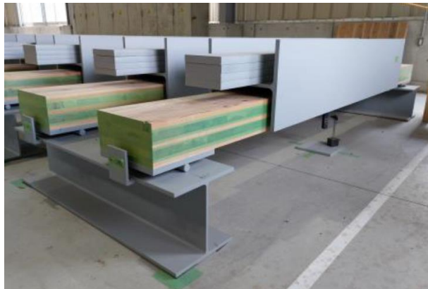
写真 面外曲げ試験
