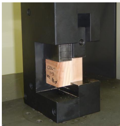
写真 ブロックせん断試験
