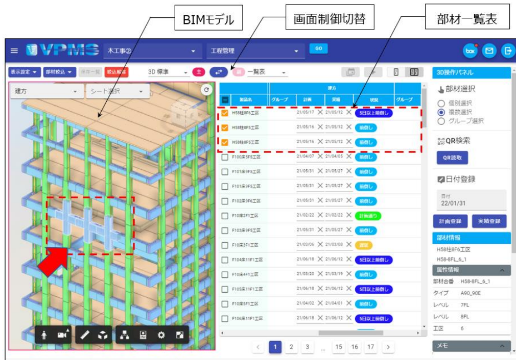
図 BIM モデルと部材情報の連携イメージ
