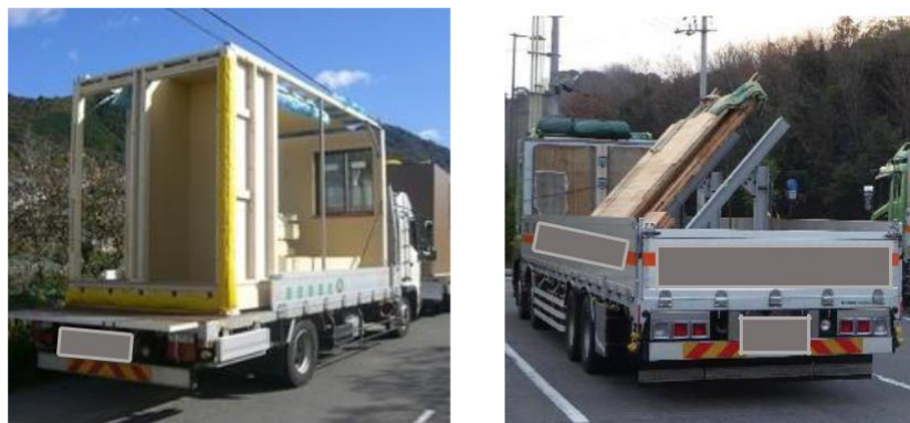
写真 縦積みの例
