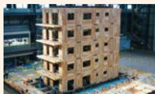
▲実大振動台実験(防災科学技術研究所)
