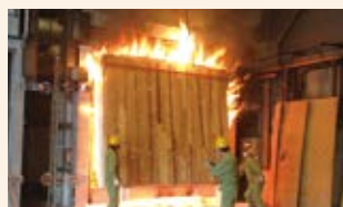
▲CLT現し壁の準耐火構造加熱実験(日本住宅・木材技術センター)
