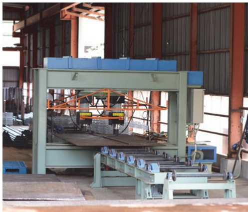
写真 4.2-3 敷鉄板の補修機械や修理の様子((株)ホンムラ ウェブサイトより抜粋)
