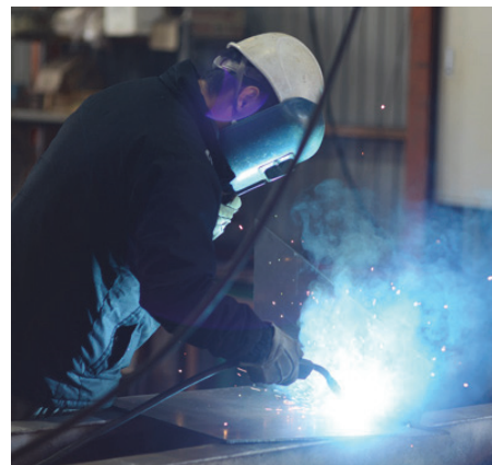
写真 4.2-3 敷鉄板の補修機械や修理の様子((株)ホンムラ ウェブサイトより抜粋)
