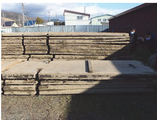
写真 2.2-3 繰り返し利用した CLT 敷板 (3 現場利用)
