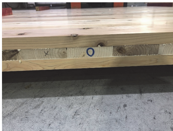
写真 2-4.3 土木用ラミナかつ樹種が混在する CLT(試験条件 3)
