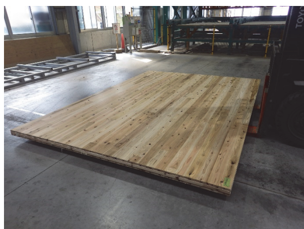
写真 2.4-1 土木用ラミナのみを用いた CLT(試験条件 1)
