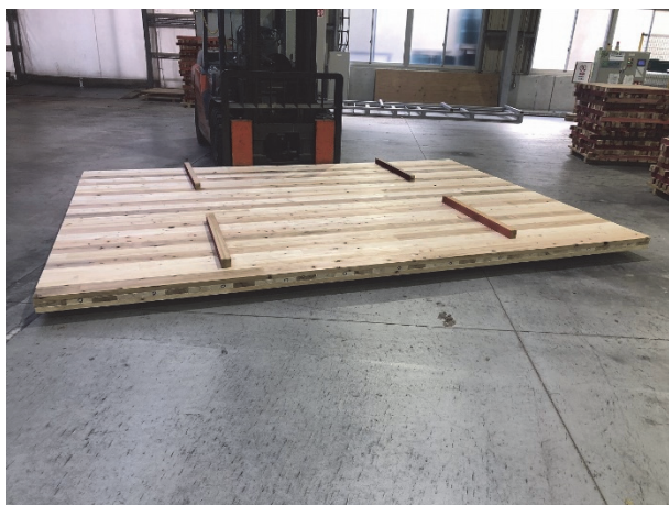
写真 2-4.3 土木用ラミナかつ樹種が混在する CLT(試験条件 3)
