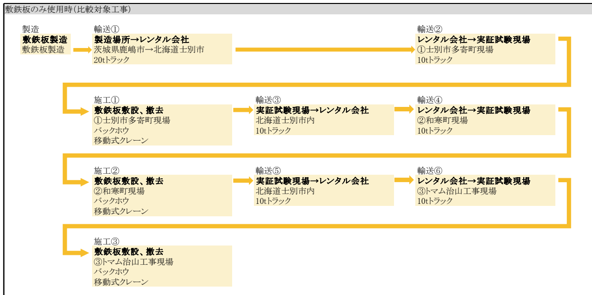
図 2.2-3 比較対象工事のフロー
