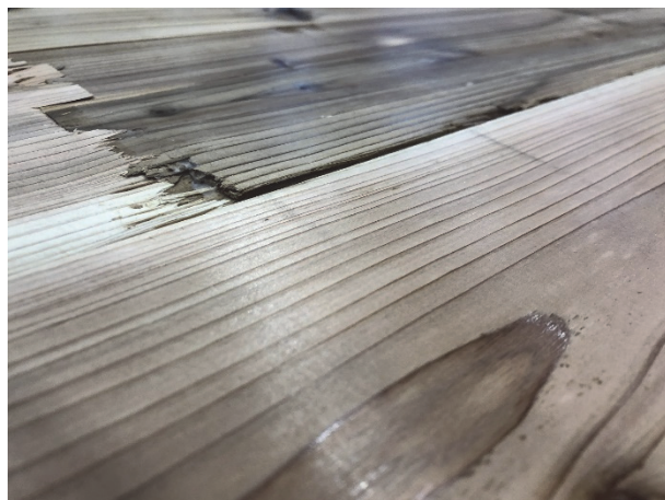
写真 2.4-2 仕上げ切削工程を省略した CLT(試験条件 2)
