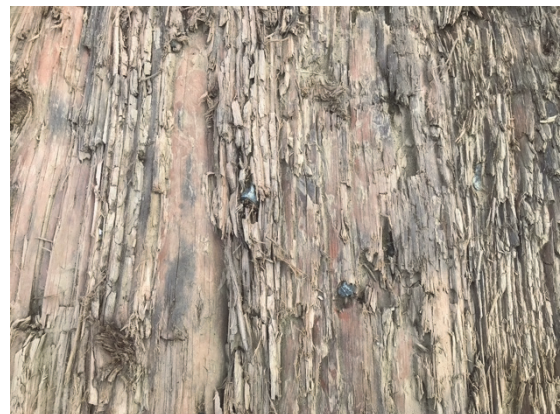
写真 4.2-2 非常に汚れが目立つ CLTmat (右は小石が入り込んでしまっている状態)
