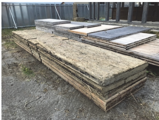
写真 4.2-2 非常に汚れが目立つ CLTmat (右は小石が入り込んでしまっている状態)
