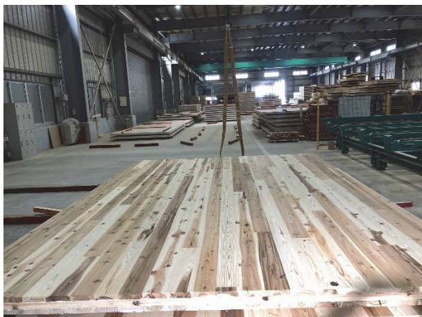
写真 2.4-2 仕上げ切削工程を省略した CLT(試験条件 2)
