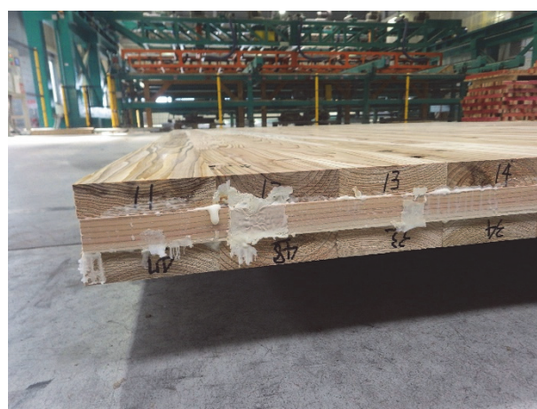
写真 2.4-1 土木用ラミナのみを用いた CLT(試験条件 1)
