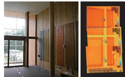
実験棟でのサーモビュア-夏季実験の結果、吹き抜けでも室温の変化が少ないことが実証されました。
