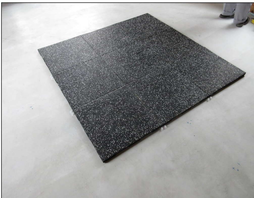
(2) ゴム製マットB (厚 30mm、計9枚を連結)
