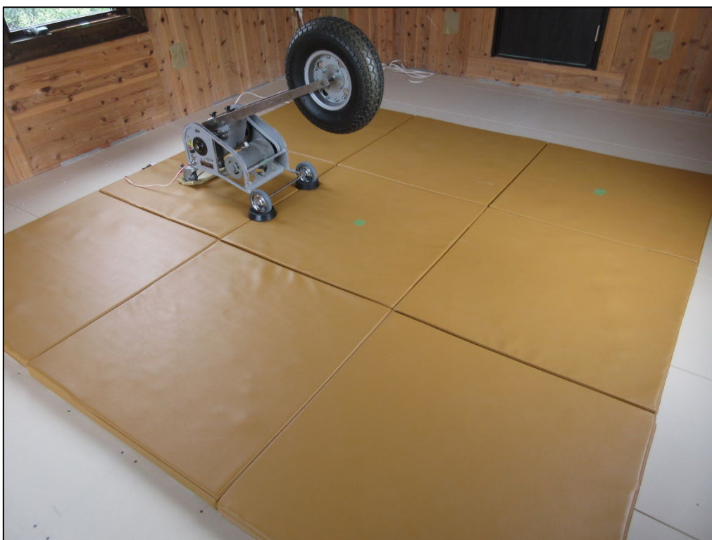
写真-2.2.13 樹脂発泡体積層マットの外観（試験体 A2）
