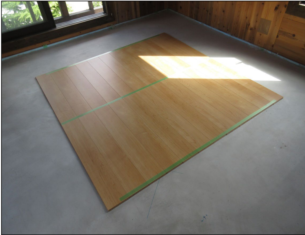
写真-2.2.25 直貼り防音フローリングの外観
