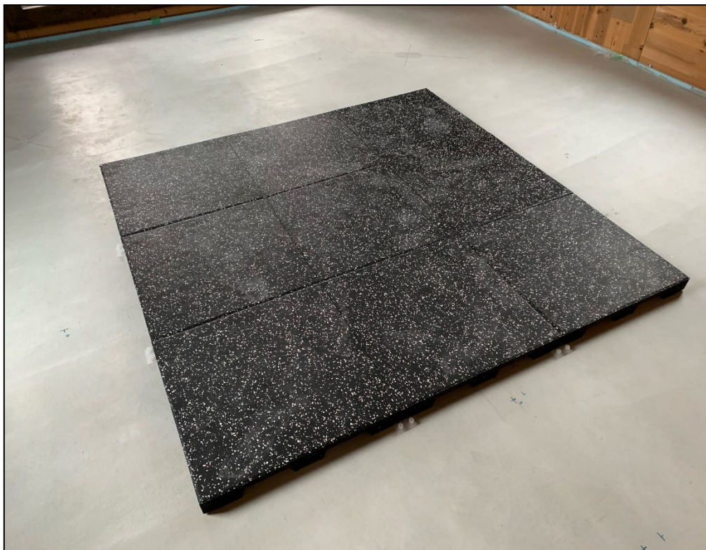
(1) ゴム製マットA (厚 50mm、計9枚を連結)
