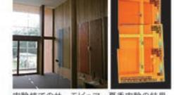
実験棟でのサーモビュア夏季実験の結果、吹き抜けでも室温の変化が少ないことが実証されました。
