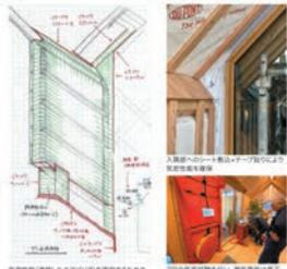
この図は、建築事務所の本社事務所のCLTの詳細図。天井のCLTの格子構造、断熱材の配置、施工方法などが詳細に示されている。
