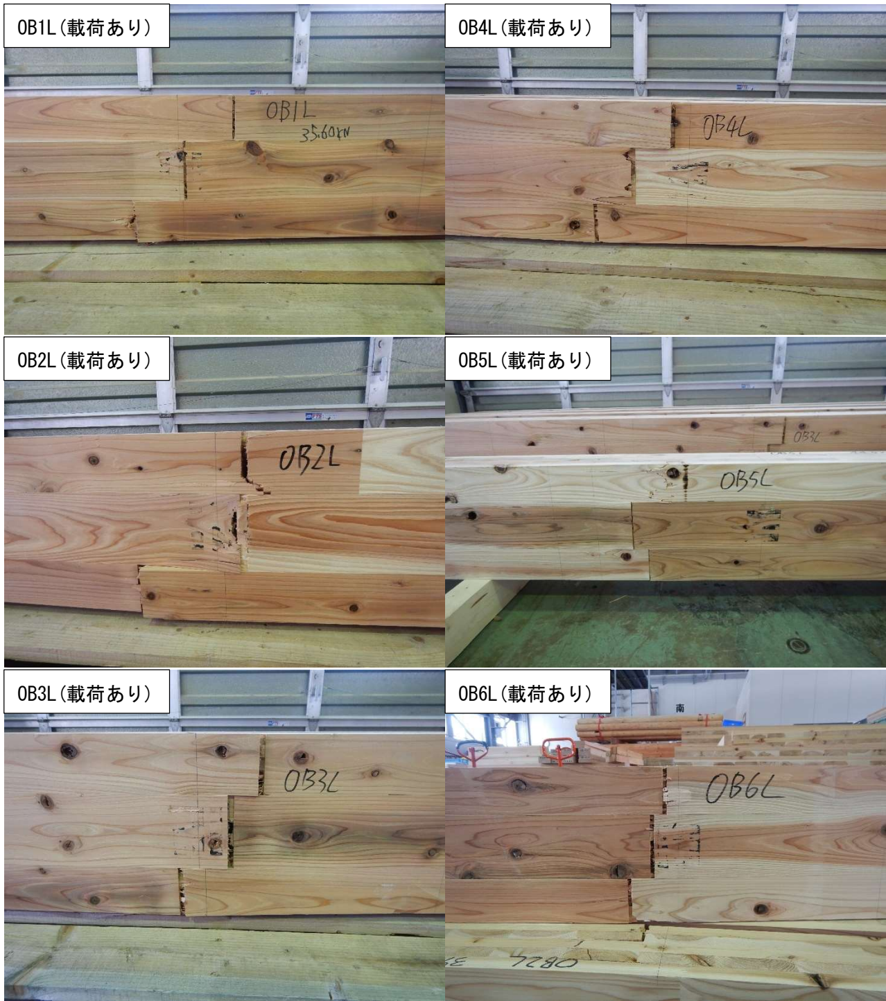
図 3-6 面外曲げ試験の破壊形態（载荷試験体）
