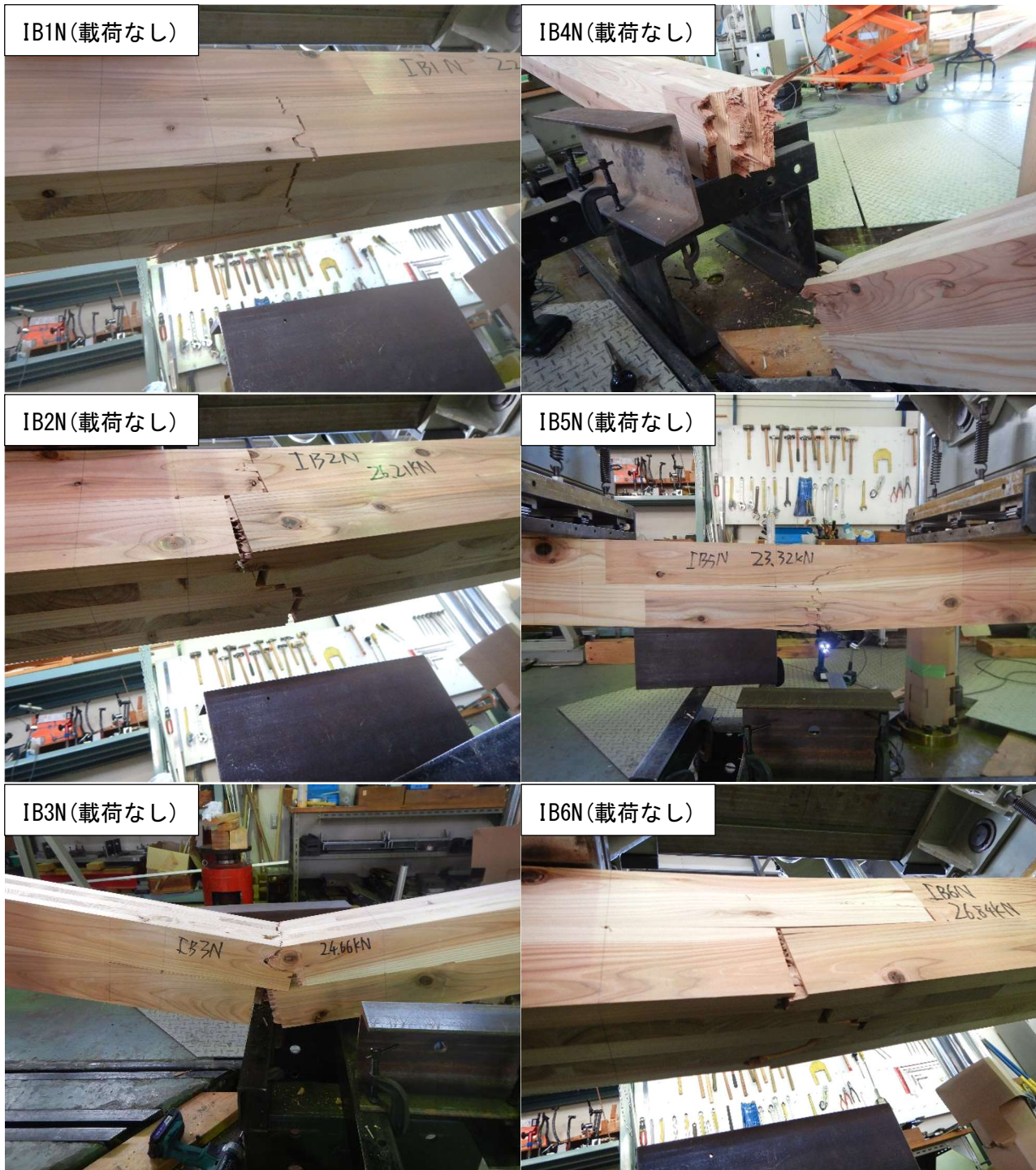
図 3-11 面内曲げ試験の破壊形態 (載荷試験体)
