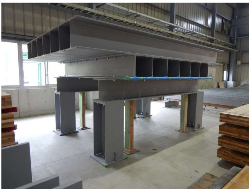
図 2-7 縦圧縮载荷試験の状況
