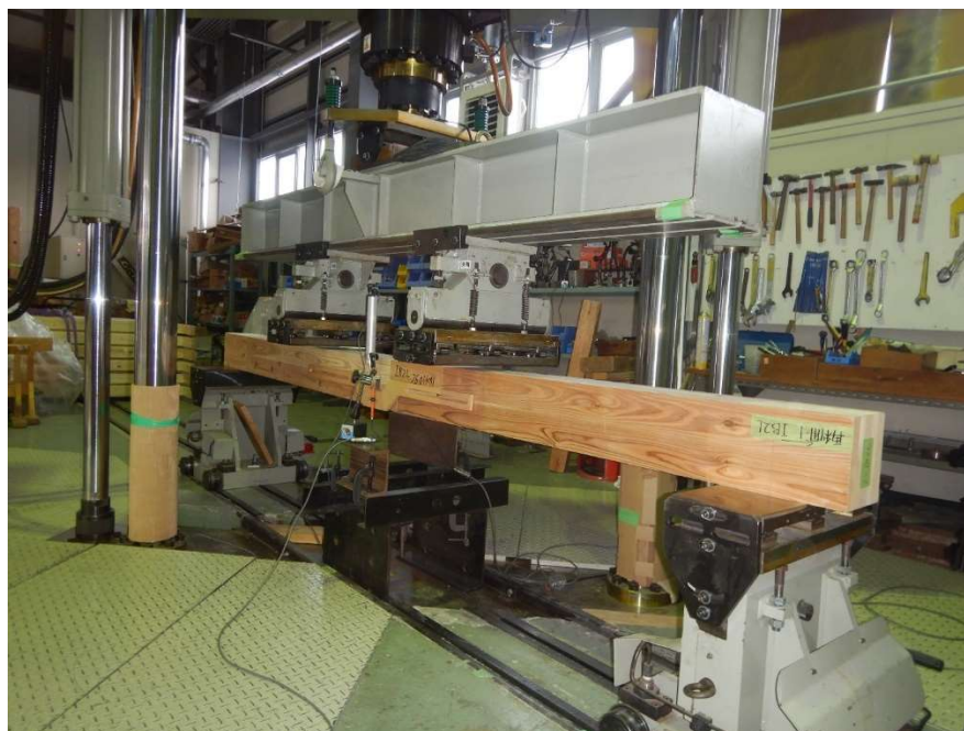
図 3-7 面内曲げ試験の様子
