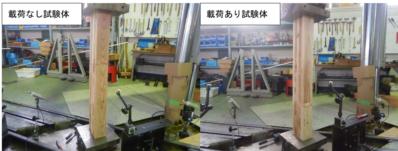
図 3-23 縦圧縮試験の代表的な破壊形態
