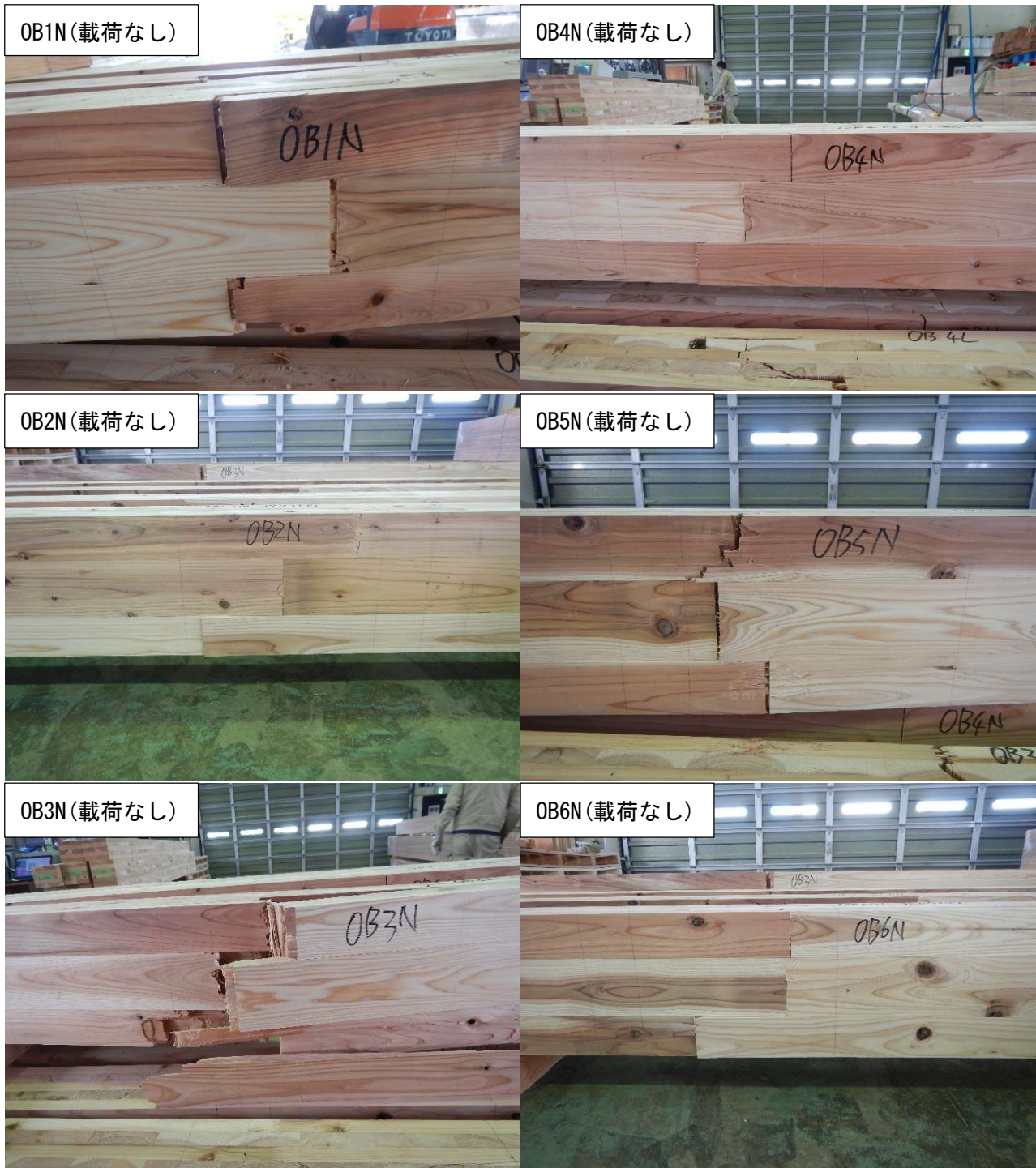
図 3-5 面外曲げ試験の破壊形態（無荷重試験体）
