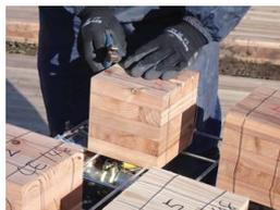
写真 1.2-1 キュービック型供試体
