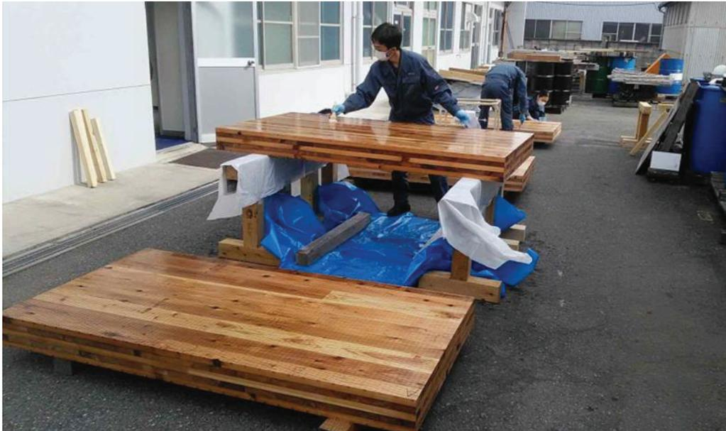
図 6.4-4 深浸潤処理用薬剤を用いた塗布処理の様子
