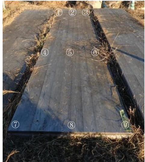
図 5.4-1 CLT 敷板の含水率測定位置
