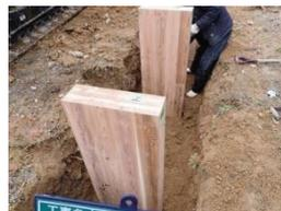
写真 1.2-2 横目ボード型供試体
