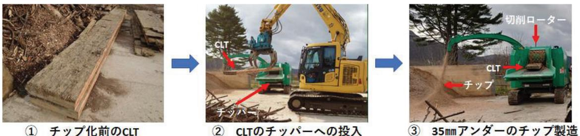
写真 1.4-3 使用済み CLT の切削チップ化の実施状況(令和 4(2022)年 11 月 15 日)
