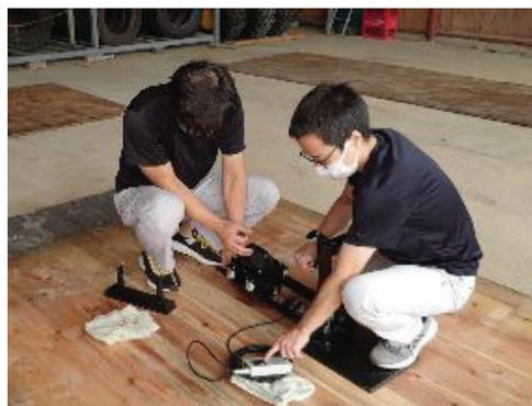
写真 5.1-44 CSR の測定状況 (CLT 敷板強軸方向の測定)
