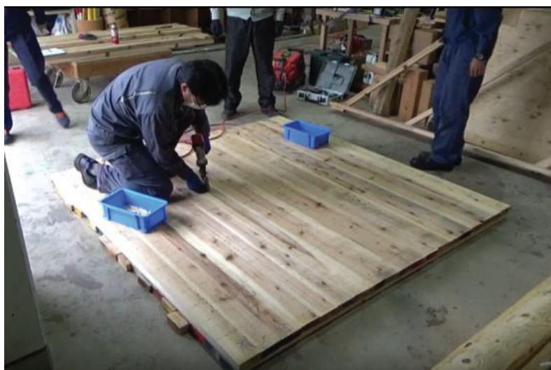
写真 6.2-11 木釘での土木用 CLT の製造の様子
