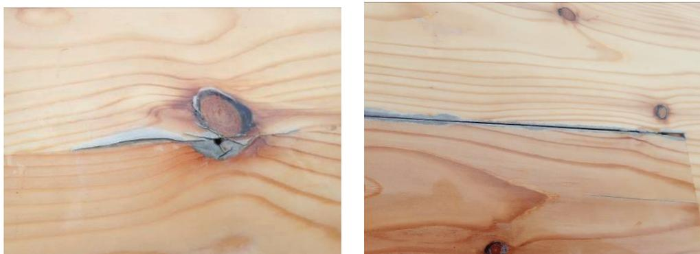
写真 5.2-27(左)写真 5.2-28(右) ポリウレアの割れ及び剥離
