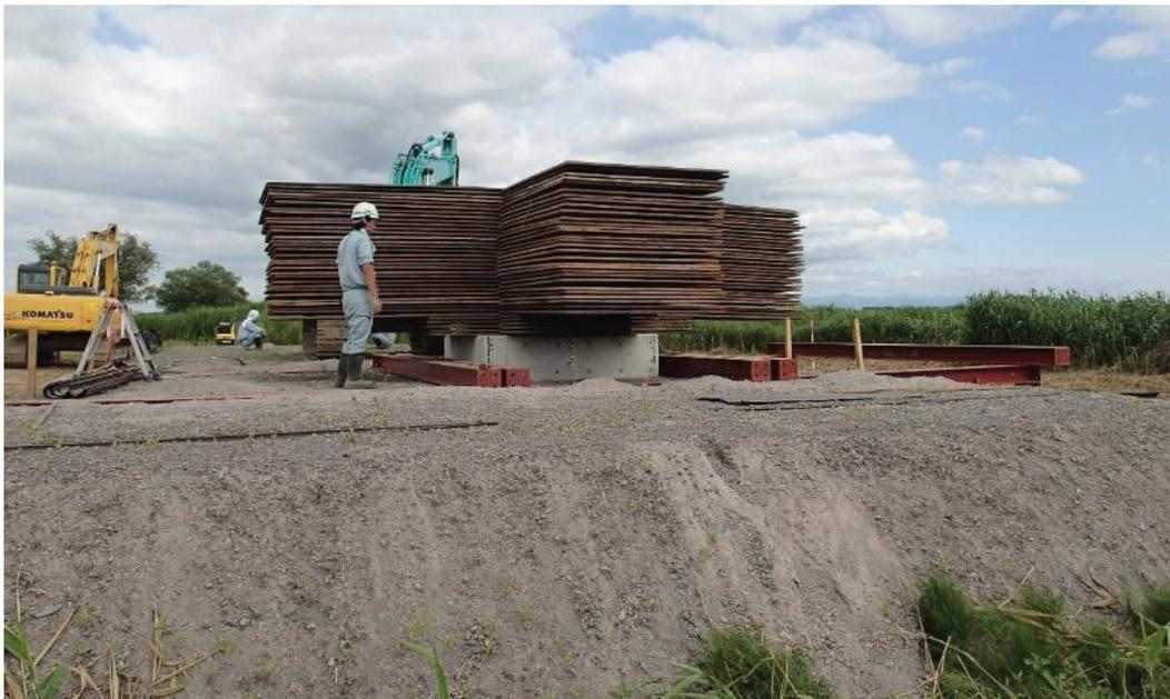
写真 4.1-3 最終荷重段階(1085.5kN、271.4kN/m<sup>2</sup>)
