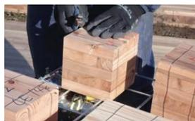
写真 3.1-1 キュービック型 供試体
