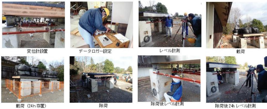
写真 4.2-2 載荷、除荷、たわみ量計測の状況
