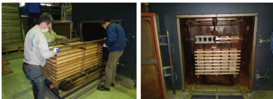
写真 6.2-1 ラミナの人工乾燥の様子
