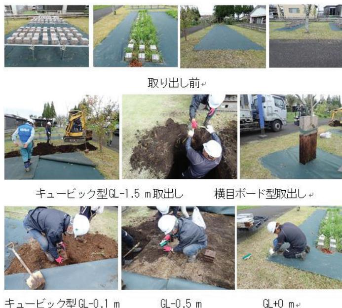
写真 3.4-3 亜熱帯 宮崎県木材技術センターでの 供試体取出し
