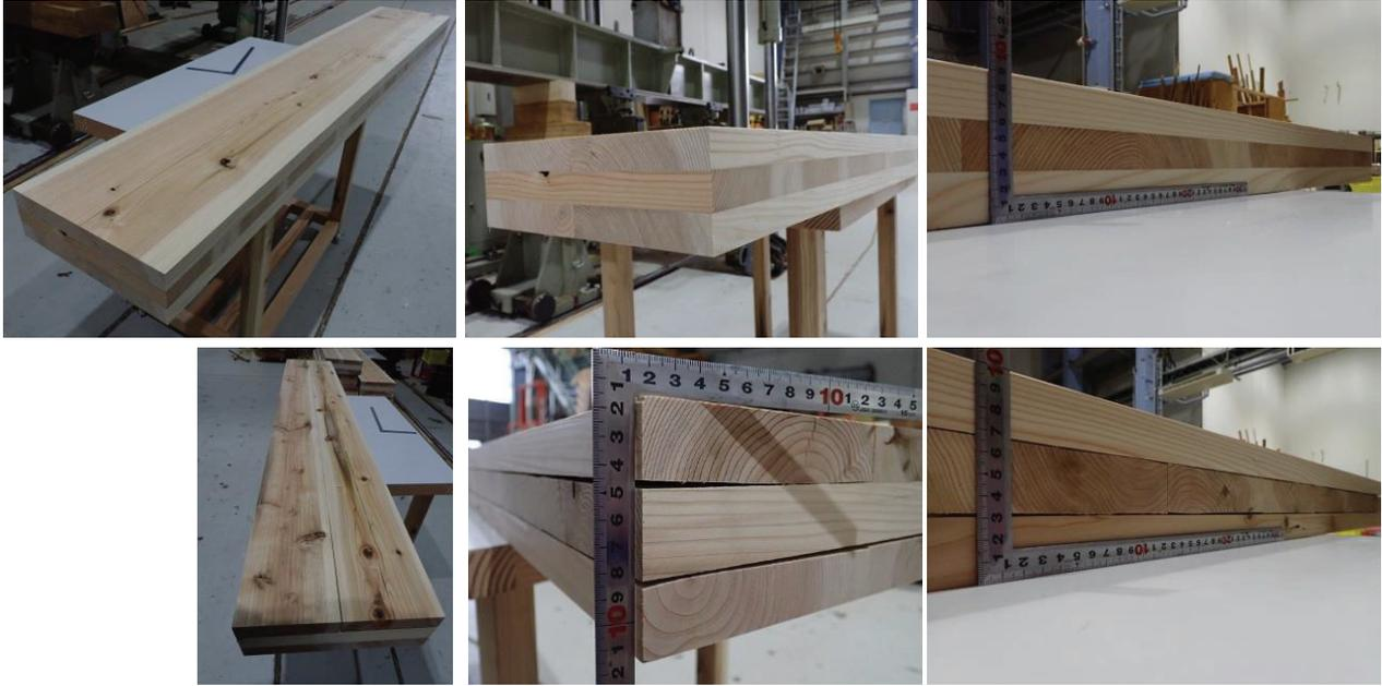
写真 6.2-6 製造した CLT(プレス)(上段:プレーナー加工あり、下段:なし)
