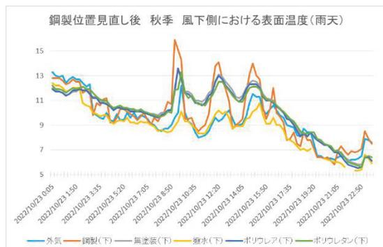
図 5.2-16(左),図 5.2-17(右)秋季風上(風下)側における表面温度(雨天)2022/10/23
