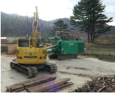
写真 5.1-13 チッパー機によって破碎される CLT 敷板
