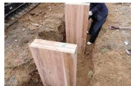
写真 3.1-2 横目ボード型 供試体
