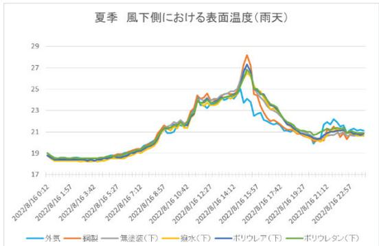
図 5.2-12(左)、図 5.2-13(右) 夏季風上(風下)側における表面温度(雨天)2022/8/16
