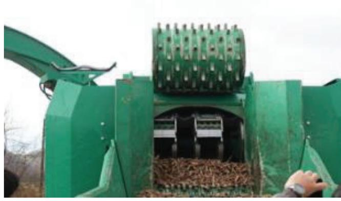
写真 5.1-14 チッパー機による破碎の様子
