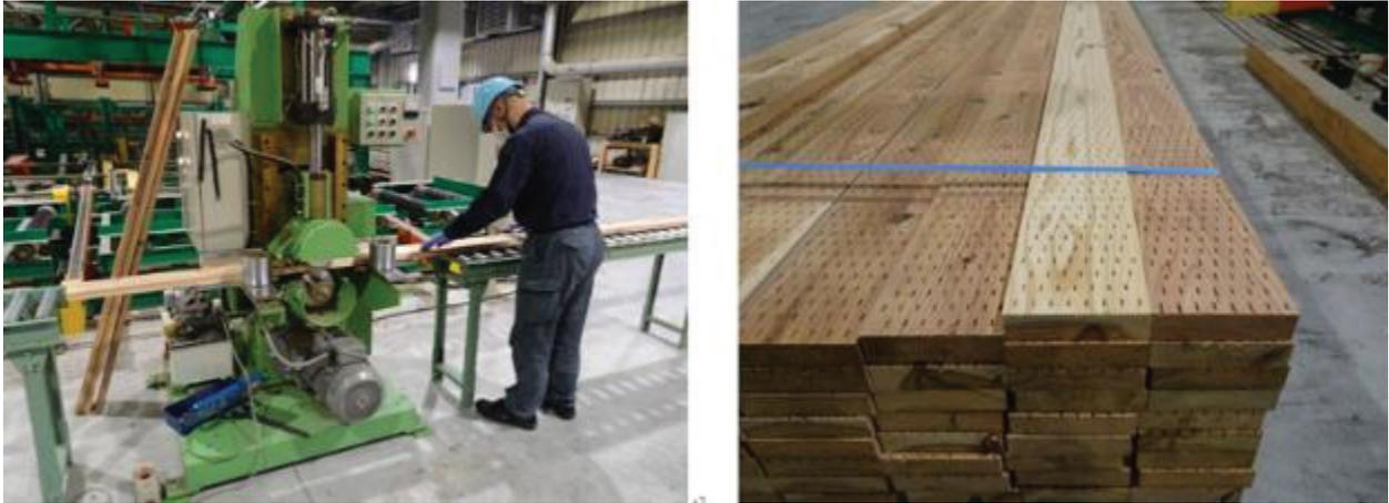
図 6.4-3 インサイジング処理の様子(左)とインサイジング処理されたラミナ(右)
