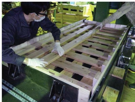
写真 6.3-2 省ラミナ CLT の製造風景
