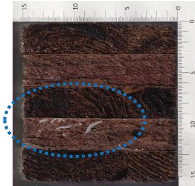
写真 1.2-8 海水環境(常時接触)での虫害
