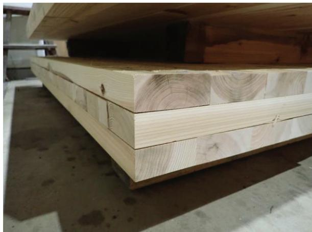
写真 6.2-12 完成した土木用 CLT(左:真空プレス、右:木釘)
