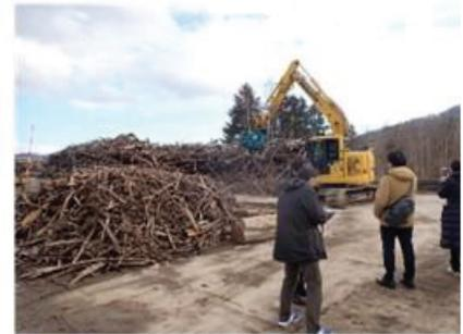
写真 5.1-42 CLT 敷板のチップ化
