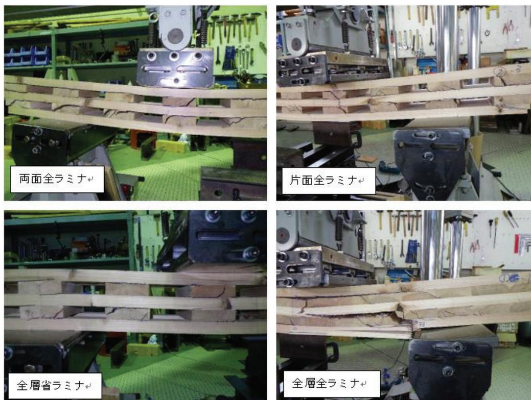
図 6.3-8 代表的な破壊形態
