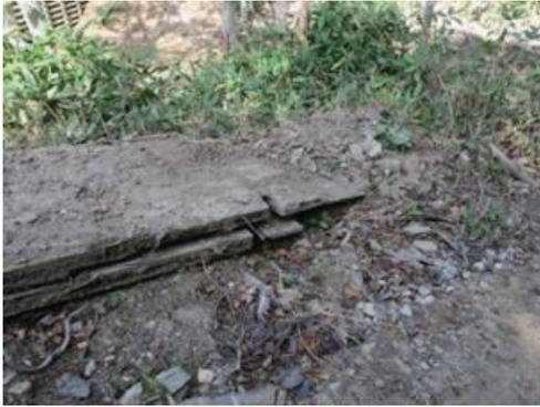
写真 5.1-10 左:破損した CLT 敷板
