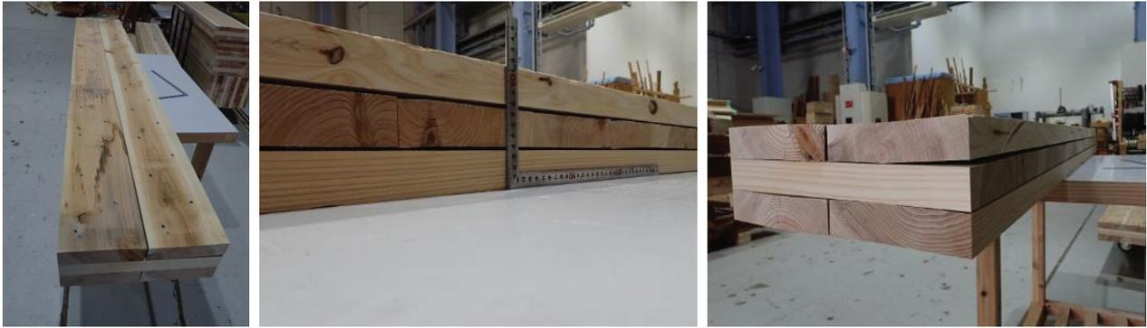
写真 6.2-8 製造した CLT(鉄釘)
