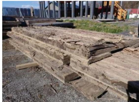
写真 5.1-12 損傷が激しい CLT 敷板
