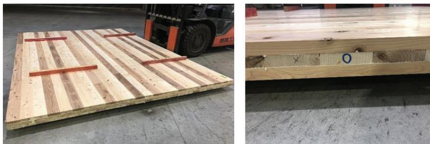
写真 6.1-5 実証仕様 3 で製造した CLT パネル
