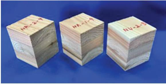
AD ラミナを使用した CLT より作製した試験片
