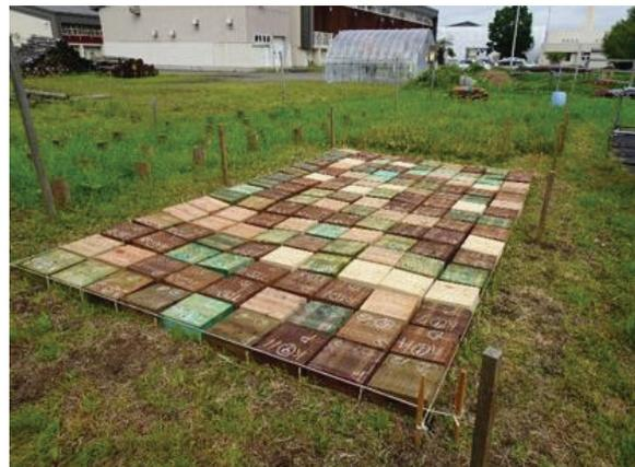
写真 6.4-2 林産試験場内の曝露試験地に設置された CLT 試験体
