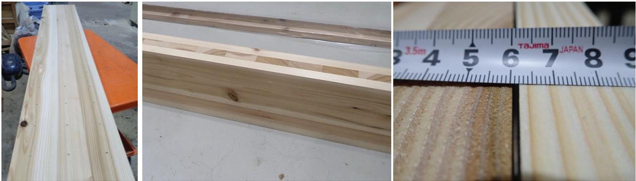
写真 6.2-9 製造した CLT(木釘)
