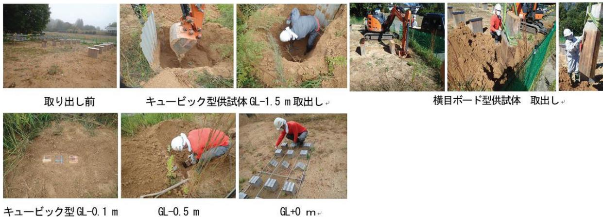
写真 3.4-2 温帯 広島県林業技術センターでの 供試体取出し
