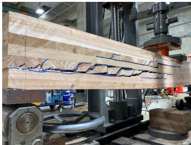
写真 2.8.4-2 せん断破壊の例（強軸）
