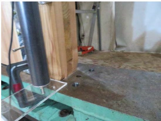
-1/15rad時 端部の圧縮変形
