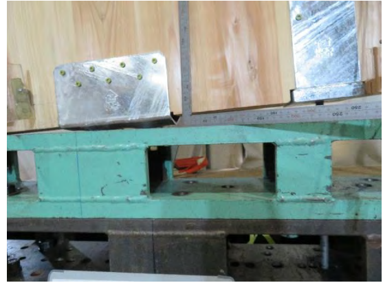
+1/15rad時 せん断金物と引張金物の変形
