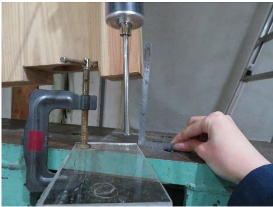
+1/8rad時 壁脚部浮き上がり
