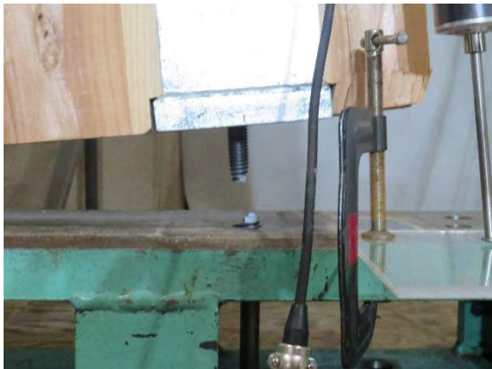
+1/10rad時 ボルトの破断
