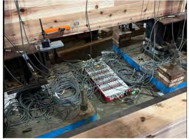
1F 変位計ケーブル接続
