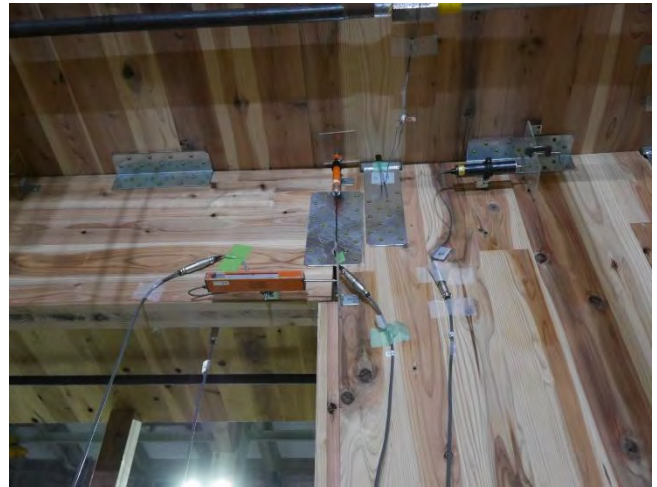
垂壁-袖壁接合部
