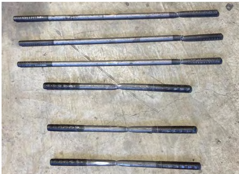
写真 2.9.3-1 試験体の破断後の様子 (上 : M16 下 : M20)
