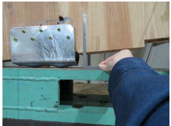
+1/10rad時 せん断金物の変形
