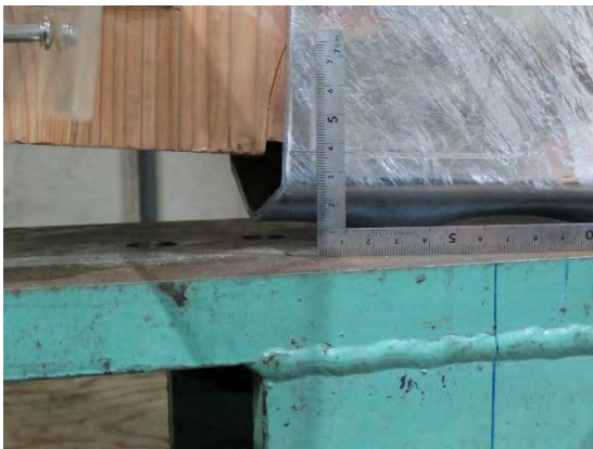
+1/15rad時 せん断金物 SP の変形
