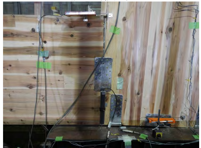
腰壁-袖壁接合部
