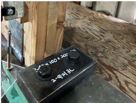
-1/30rad 時 CLT の割れ
