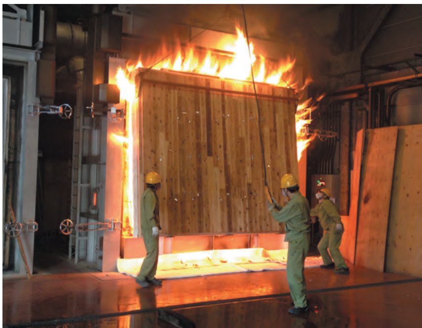
日本住宅・木材技術センターの耐火炉で実施された、CLT現し壁の準耐火構造加熱実験。木材が毎分約1mmの速度でゆっくり燃え進むことを利用して、厚さ90mmのCLTが1時間で約60mm燃えた際にも壁が燃え抜けないことを確認。
