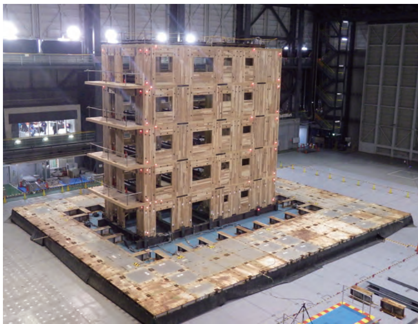
防災科学技術研究所の3次元振動台“E-ディフェンス”で実施された実大振動台実験。写真の5階建と3階建の試験建物に対して、阪神淡路大震災の観測波よりも大きな加力を入力し、変形量、破損部位を調べ、倒壊しないことを確認。
