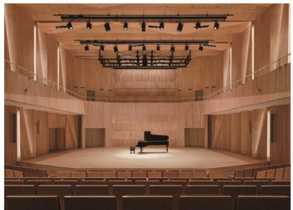
現して使用したCLTは、構造だけではなく音響反射としても寄与
