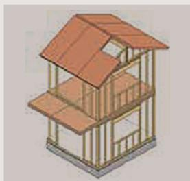
枠組壁工法+CLT
