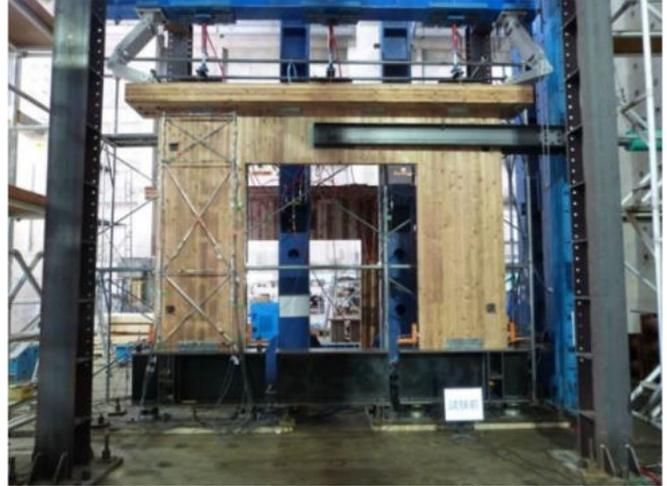
図 4.4.1-1 既往文献の構面試験体概要 (C09a 試験体)
