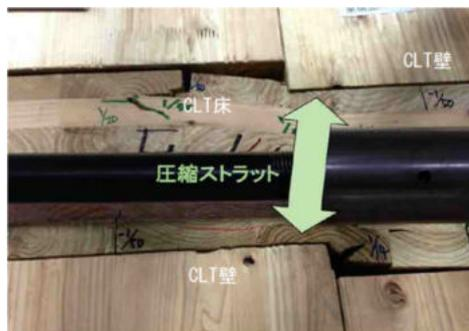
図 2.2.1-9 圧縮ストラット効果 (連続壁パネル継ぎ目位置における床パネルの面外変形状態)
