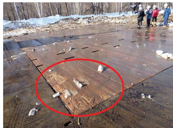
写真 5.3-8 CLT の損傷（積込ヤード）
