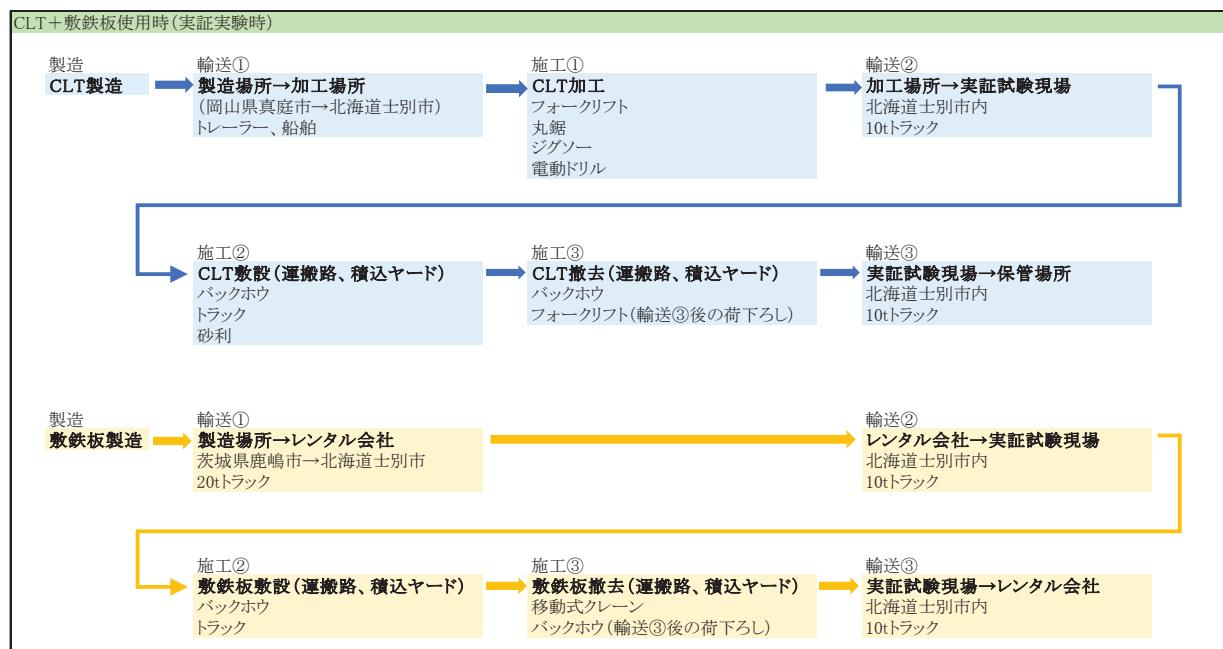
図 5.3-3 CLT 敷板を使用する工事のフロー
