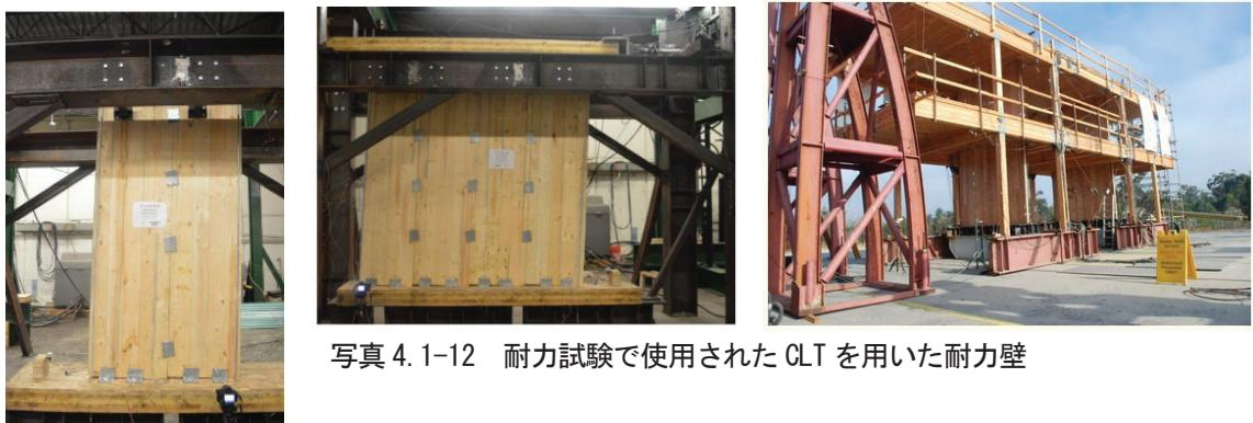
写真 4.1-12 耐力試験で使用された CLT を用いた耐力壁
