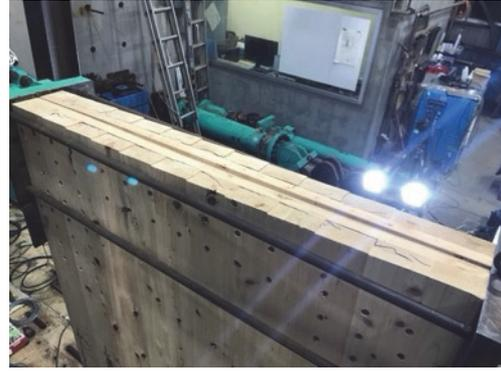
(b) CLT のせん断破壊の様子（上面）
