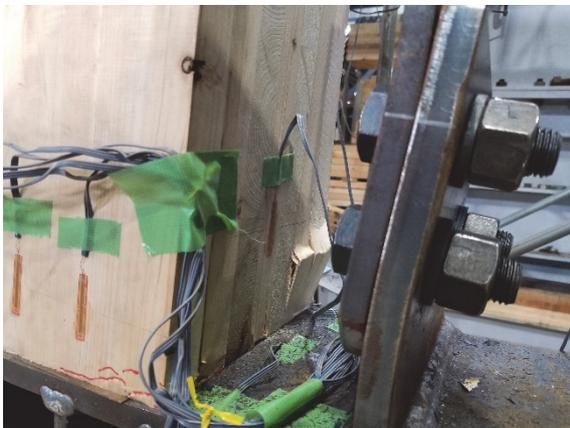
(5) 1/20rad CLT 端部の圧縮破壊
