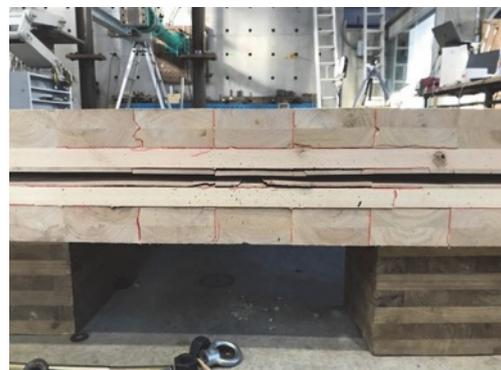
CLT のせん断破壊の様子（下面）
