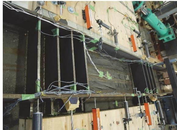
(4) 1/20rad 鉄骨はりの曲げ変形
