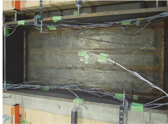
(2) 1/75rad 鉄骨はりウェブ表面のひび割れ
