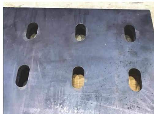
(f) せん断接合部の挿入鋼板
