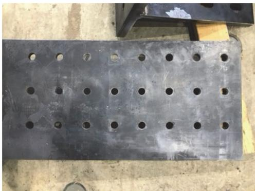
(e) せん断接合部の挿入鋼板
