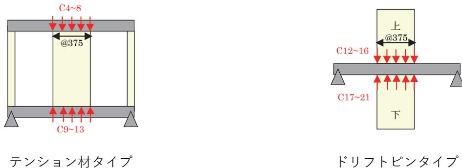
図 4.3-63 CLT 脚部変位計位置概要図
