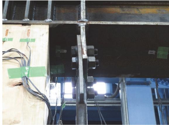
(2) 1/75rad ガセットプレートの面外変形
