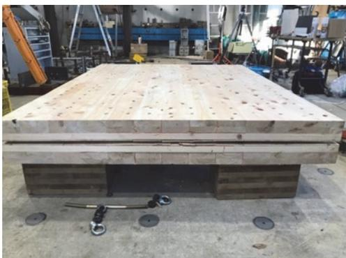
CLT のせん断破壊の様子（下面）
