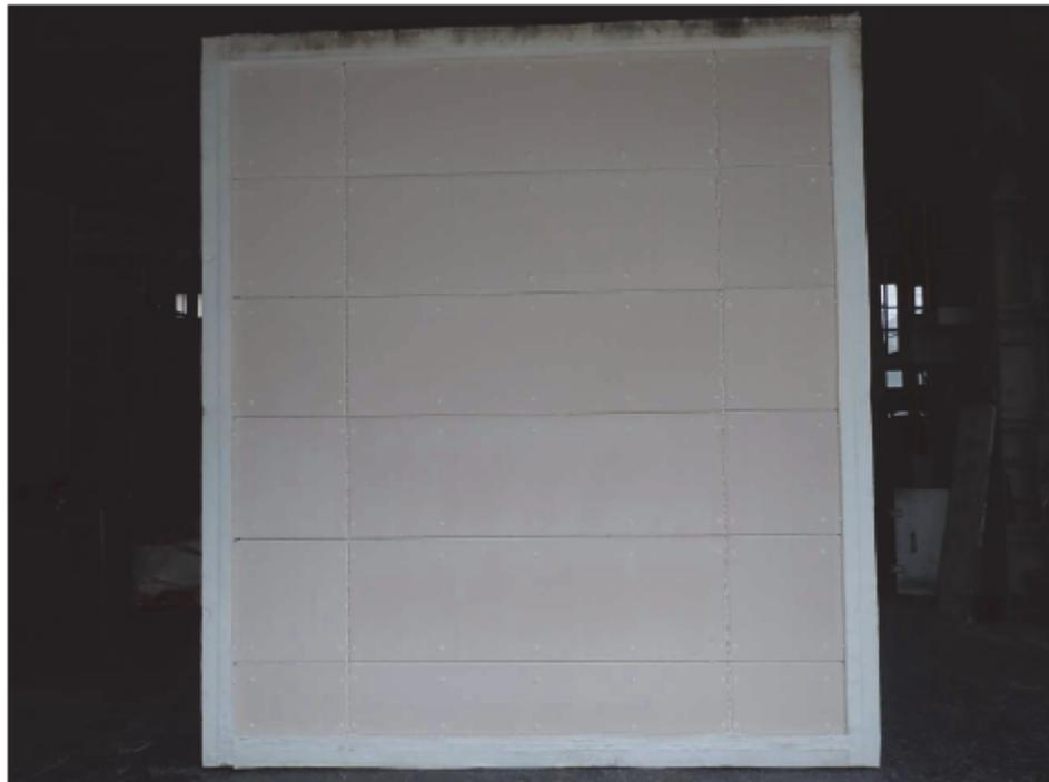
写真 6.3-4 試験後の加熱側（屋外側）の状況
