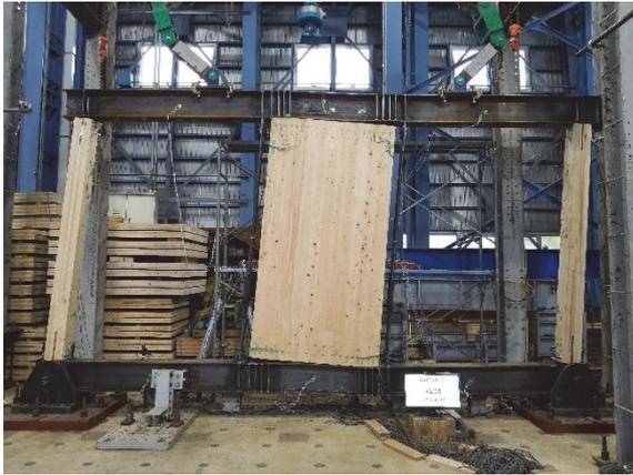
(1) 最大変形時 試験体全体
