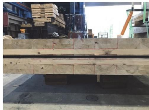
(h) CLT のせん断破壊の様子 (下面)
