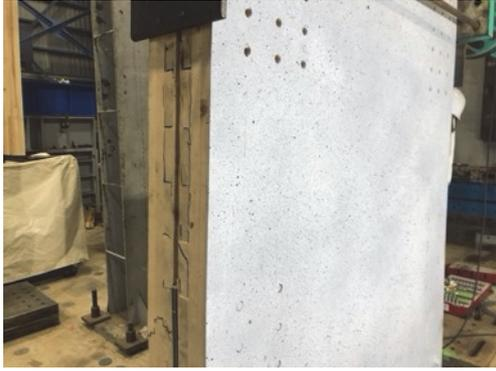
(a) CLT のせん断破壊の様子（側面）
