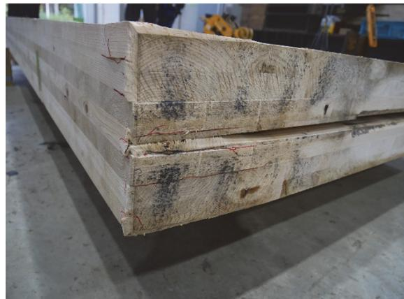
(6)解体後 CLT 端部の破壊
