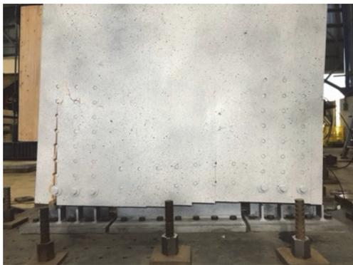
(c) 試験後の CLT の破壊
