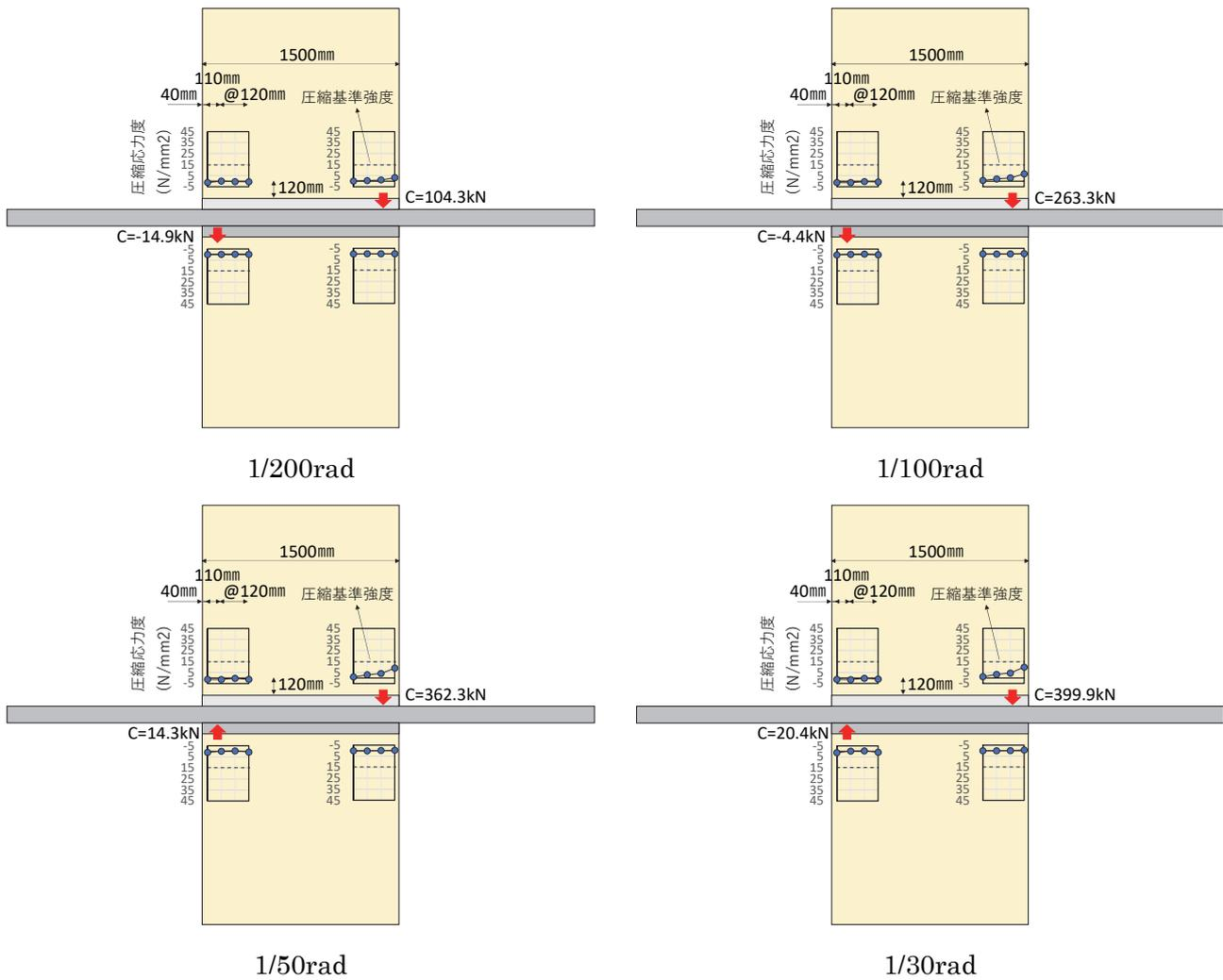
図 4.3-48 No.3-片側モルタルあり-24DP CLT 端部圧縮応力度
