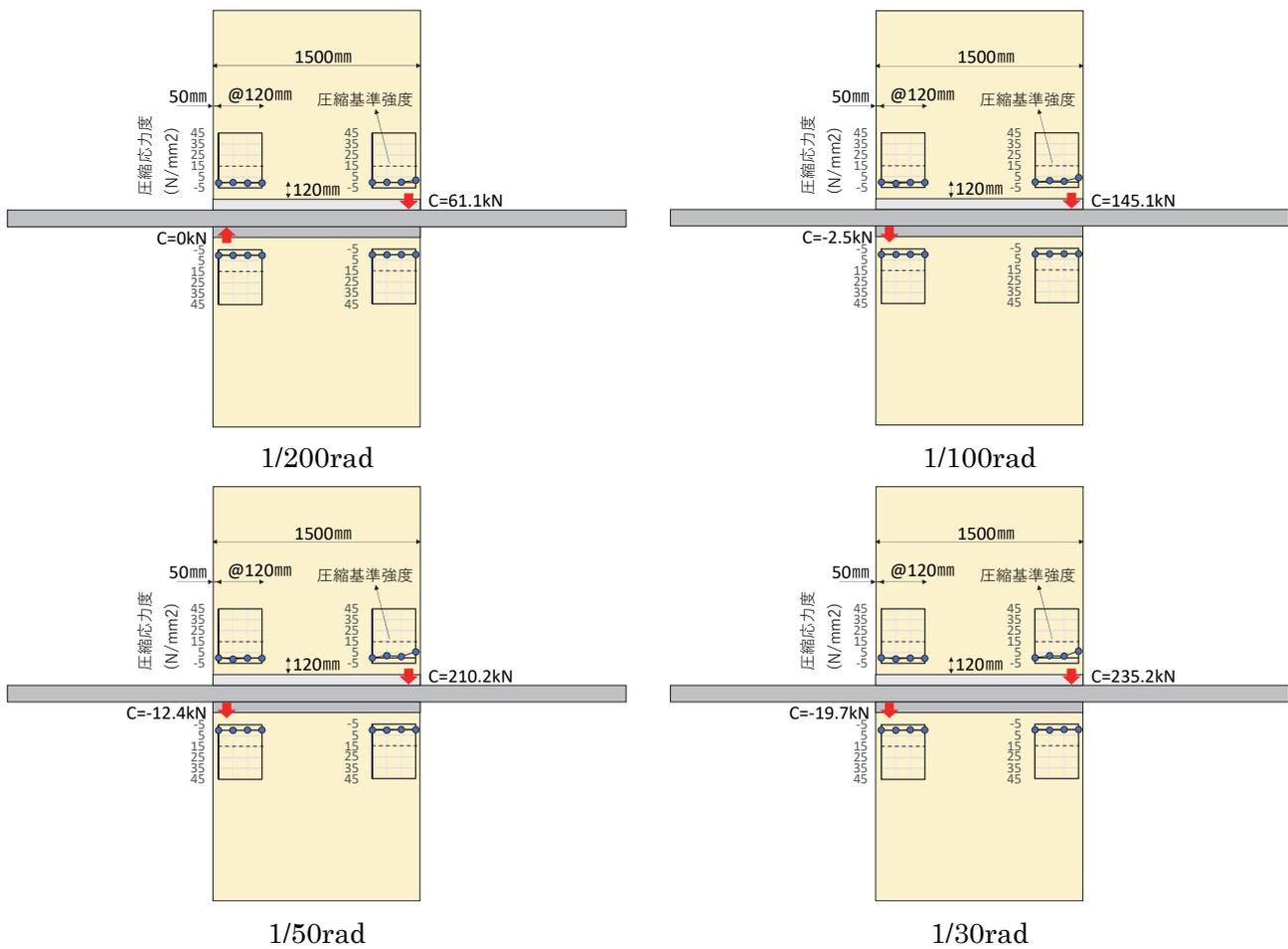
図 4.3-52 No.5-片側モルタルあり-16DP CLT 端部圧縮応力度
