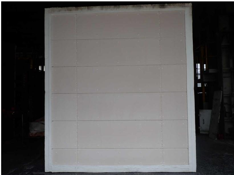
写真4 試験後の加熱側（屋外側）の状況
