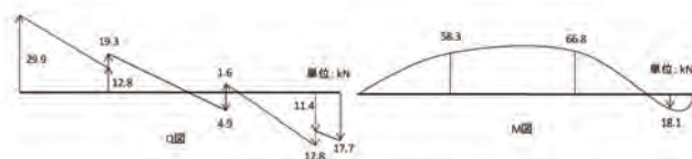
図8.2-2 水平構面検定用値の算定
