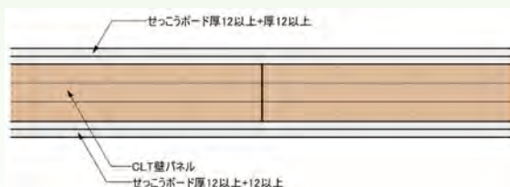
間仕切壁（1時間準耐火構造）（耐力壁）仕様例（水平断面図） （引用：「実務者のためのCLT建築物設計の手引き」）
