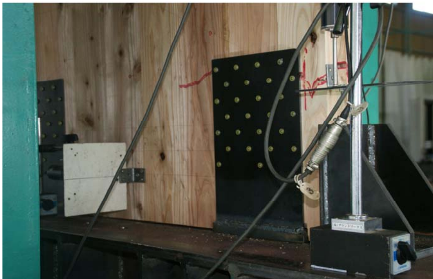
写真4.1.16 側面左 U形金物ビス接合部の亀裂
