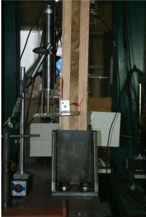
写真4.1.10 側面左 U形金物ビス接合部の亀裂
