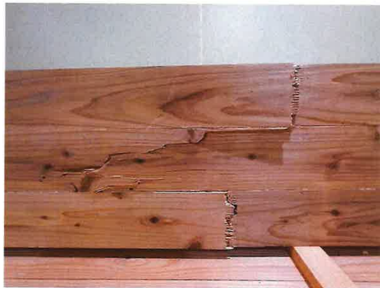
図 8 節を起因とする破壊（中央のラミナ）
