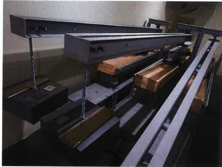
図 2 長期荷重試験の荷重状況
