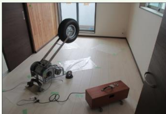
音源室（上階、衝撃源設置状況）
