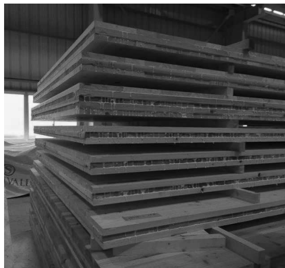
写真：最外層がヒノキ、内層がスギの CLT
