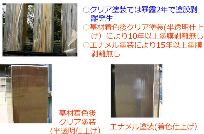
図 17 :フッ素系塗装の基材及び塗膜の着色による耐候性向上効果
