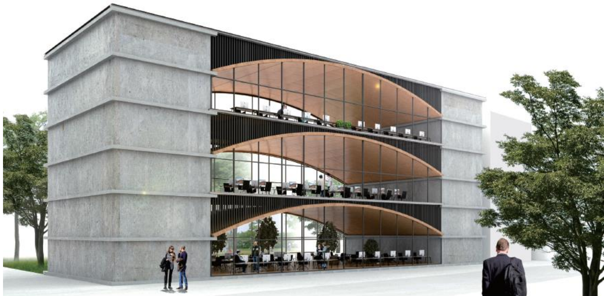
CLT-Vault カタランヴォルトから着想を得た、低ライズの木造ヴォールト空間の提案
