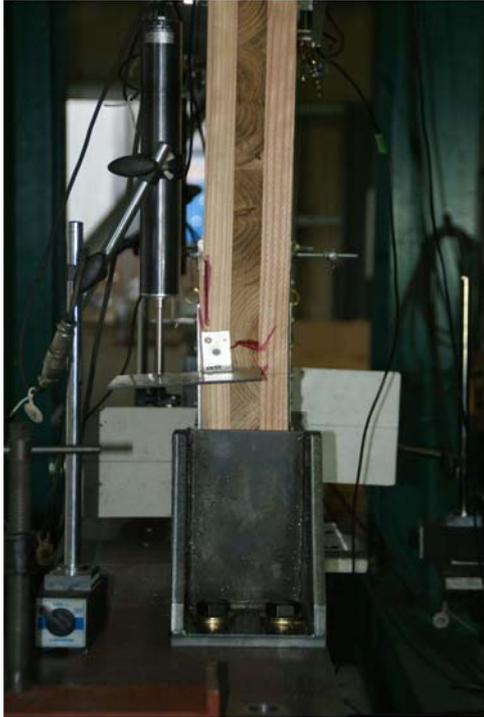
No2は、金物のビス接合上部に70 k N程度の加力から外層ラミナに亀裂が生じ荷重を増加させると内層ラミナはばはぎ部分が分離し隙間が発生した。
