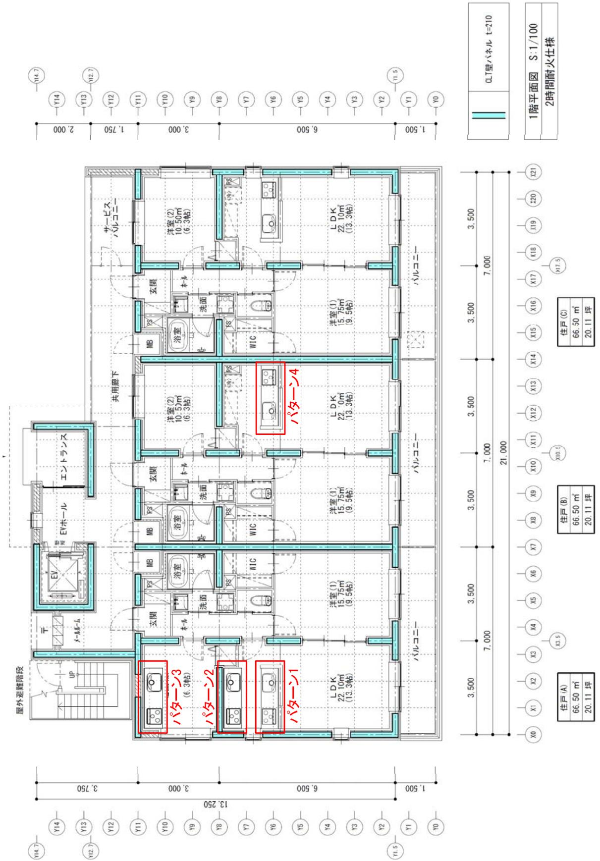
＜パターン1\_X0,Y5～Y6の壁パネル※引きボルト用開口位置の変更＞
