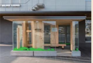
5層150mmのCLTの屋根を4層120mmの巾1m程のCLT壁4枚で支える、日本で最初に出来たCLT建築物。
