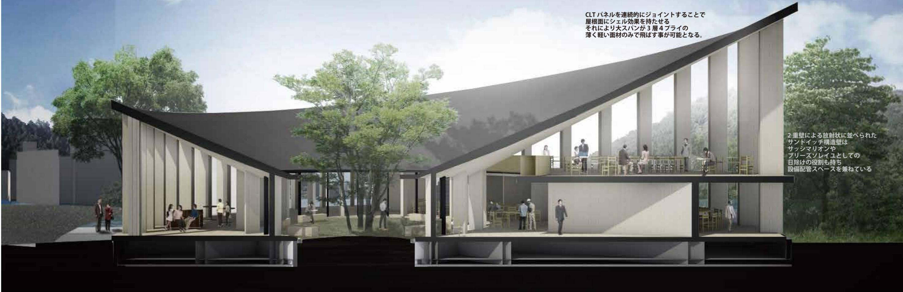
CLT パネルを連続的にジョイントすることで屋根面にシェル効果を持たせる
