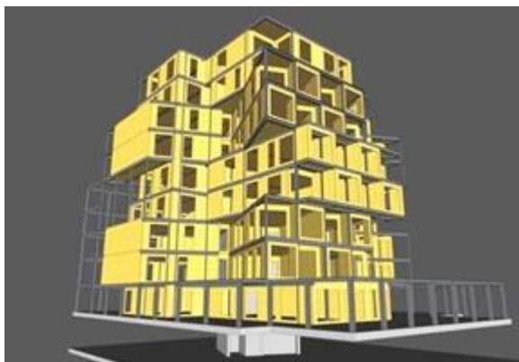
図1-1 構造図(1階とセンターコアはRC造、2階以上は鉄骨・CLTハイブリッド構造) *1
