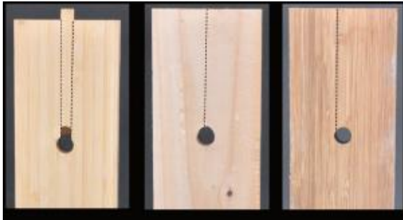
図 8-1 一般木材と竹繊維を接着した板材のボルト穴せん断強度試験 *8
