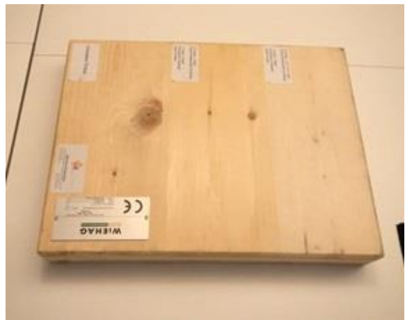
写真 3-7 防火塗料のサンプル (左部が無塗装、中央部がクリア系、右部がホワイト系)
