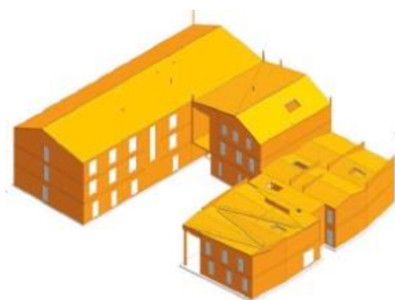
図 3-3 建物のアイソメ図(右側2階建ての屋根が折板構造) *3
