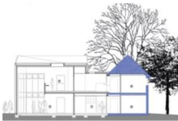
図 3-1 立面図（右側青色部が既存建物、左側灰色部が CLT 増築）*2
