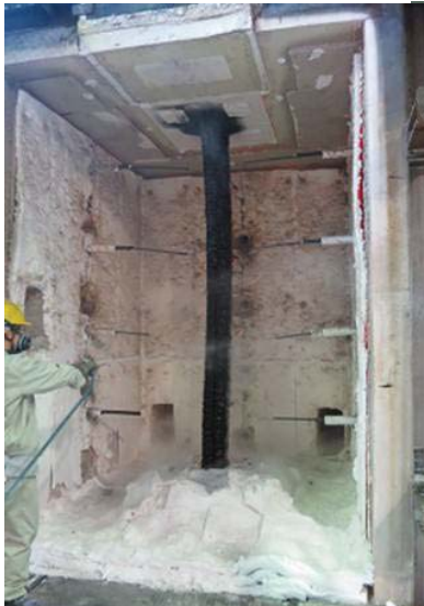
写真 5.2.4-8 消火直後の試験体
