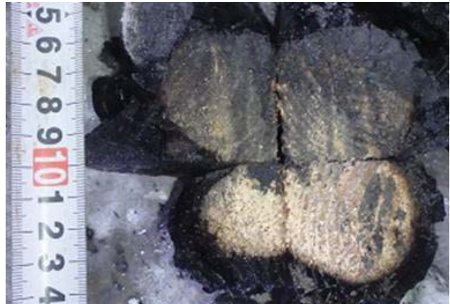
写真 5.2.4-12 試験体切断面 (中央部[地])
