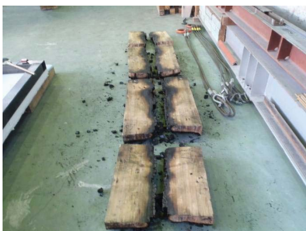
写真5.1.4-7 集成材はりの内側炭化状況
