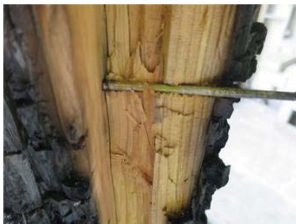
写真 5. 2. 4-13 接合具が接する木材の状況 (TC-1)
