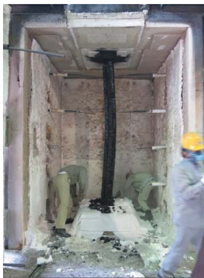
写真 5. 2. 4-2 消火直後の試験体
