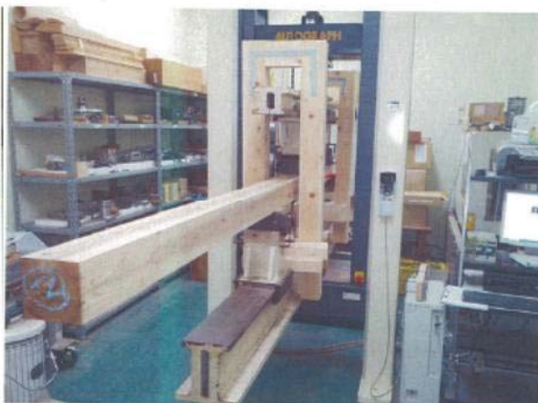
写真 5.2.2-2 静的ヤング係数の測定
