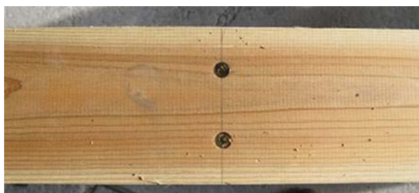
写真 5.2.2-5 建築用ビスの打ち込み
