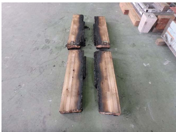
写真5. 1. 4-23 集成材はりの内側の炭化状況
