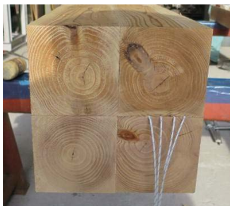
写真 5.2.2-6 構造用製材を使用した合わせ柱の木口断面
