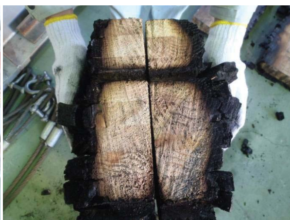
写真5.1.4-8 ボルト部分の燃え込み
