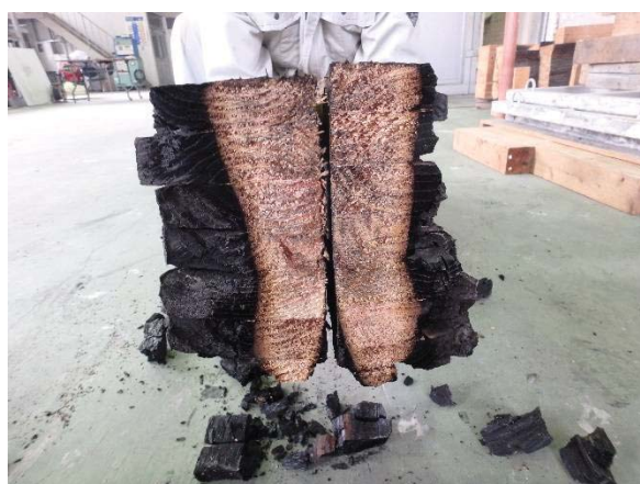
写真5. 1. 4-24 中央部分の燃え込み
