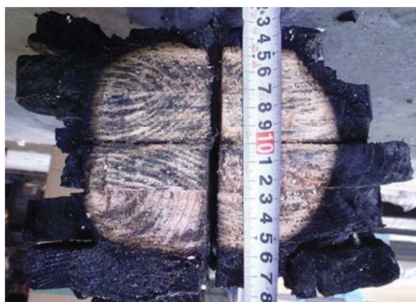
写真 5. 2. 4-5 試験体切断面 (上端部から 1 m 部[天])
