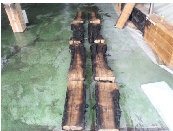
写真5.1.4-15 集成材はりの内側の炭化状況
