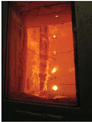
写真 3.3.4-9 加熱開始 63 分 15 秒 (座屈開始直前)
