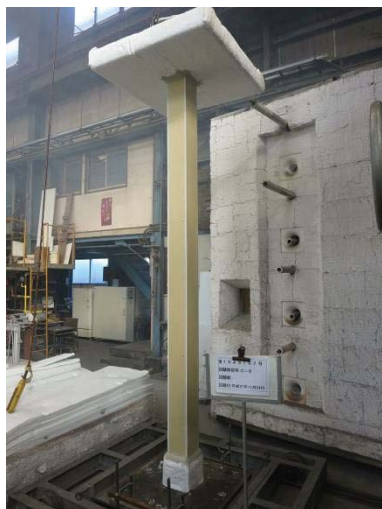
写真 3.3.4-21 加熱前試験体全景
