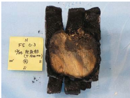
写真 3. 3. 4-39 炭化状況 (C-3)
