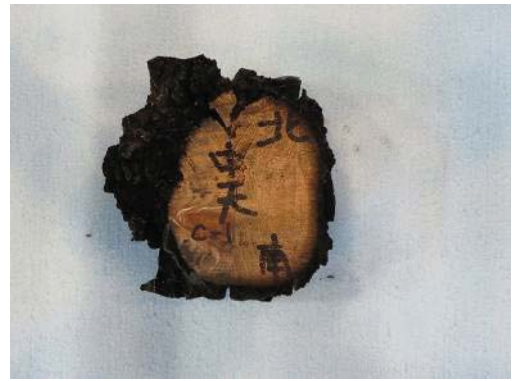
写真 3. 3. 4-32 炭化状況 (C-1)
