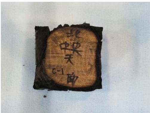
写真 3. 3. 4-33 炭化状況 (C-1)
