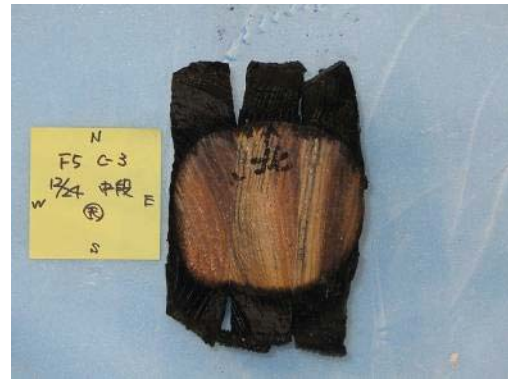
写真 3. 3. 4-38 炭化状況 (C-3)
