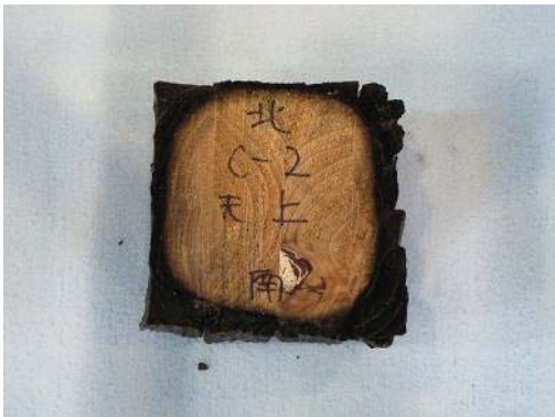
写真 3. 3. 4-34 炭化状況 (C-2)
