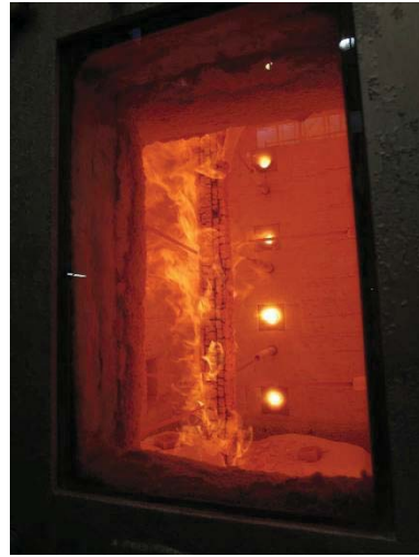
写真 3.3.4-28 加熱開始 52 分 20 秒 (座屈直前)
