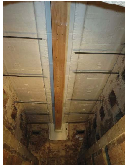
写真 3.2.4-2 加熱前の炉内配置
