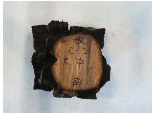
写真 3. 3. 4-35 炭化状況写真 (C-2)
