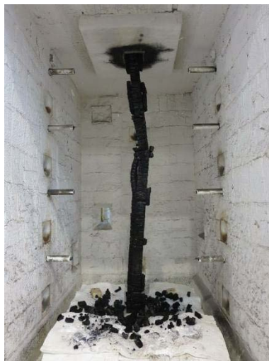
写真 3.3.4-11 加熱終了後 (消火後)
