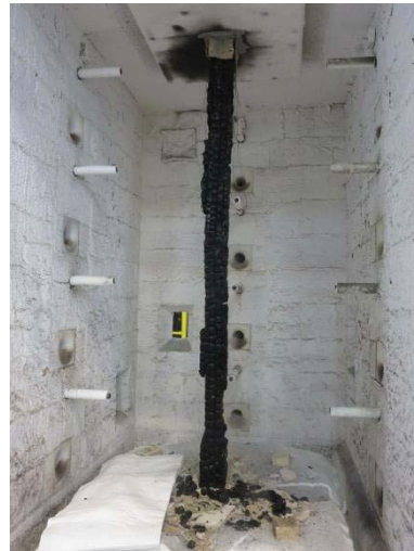
写真 3.3.4-30 加熱終了後 (消火後)
