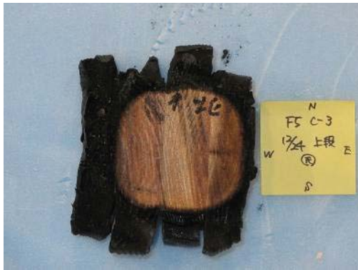
写真 3. 3. 4-37 炭化状況 (C-3)
