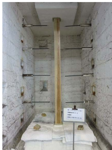
写真 3.3.4-13 加熱前炉内配置
