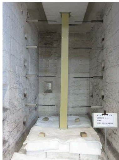
写真 3.3.4-22 加熱前炉内配置
