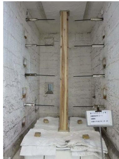
写真 3.3.4-2 加熱前炉内配置
