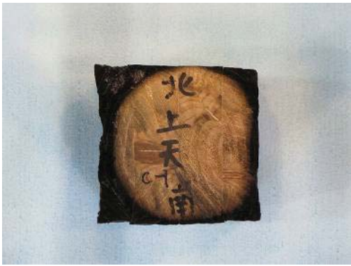
写真 3. 3. 4-31 炭化状況 (C-1)
