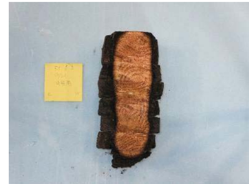
写真 3. 2. 4-27 炭化状況写真(B-2)
