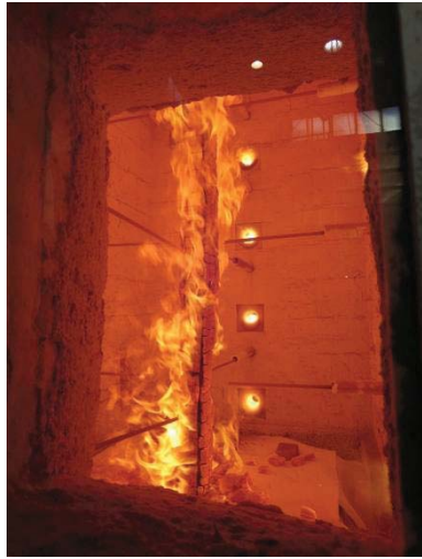
写真 3.3.4-18 加熱開始 45 分 (座屈直前)
