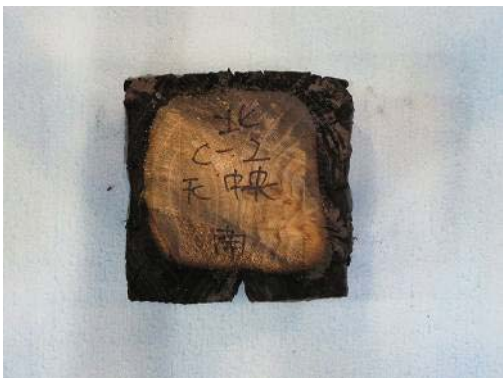
写真 3. 3. 4-36 炭化状況 (C-2)
