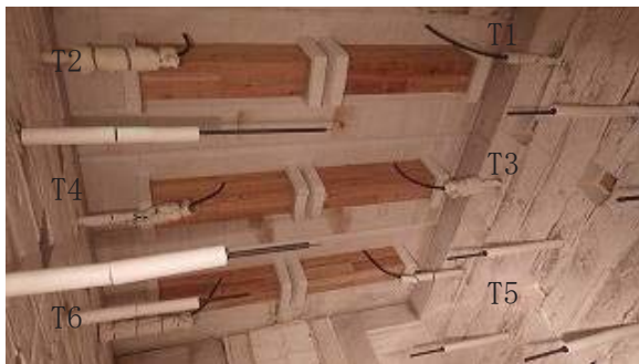
写真 3.1.4-1 加熱前炉内の試験体配置
