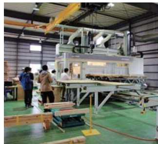
プレカット工場で、パネルサイズと金物の取付け部分や接合部を加工。
